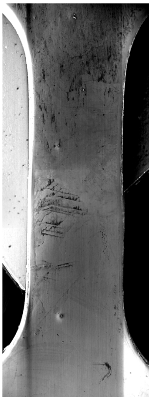
Figure 86.1 - Déformation de l'éprouvette (MEB).
