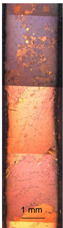
Figure 83.1 - Déformation de l'éprouvette (MOLP).
