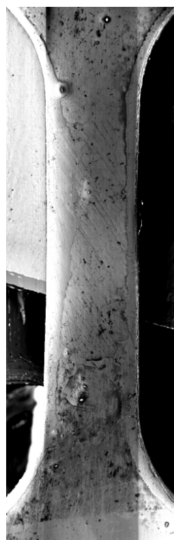
Figure 95.1 - Déformation de l'éprouvette (MEB).
