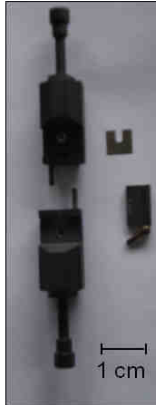
Figure 37 - Amarrage pour la machine de traction de 10 tonnes.
