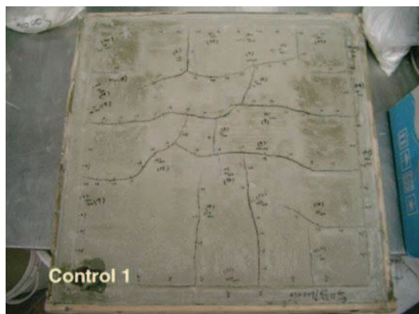
Figure 106 Dispositif de retrait restreint proposé par (Lin, et al., 2010) (à gauche) et exemple d'un réseau de macro fissure sur une plaque de mortier obtenu par ce type expérience (à droite)
