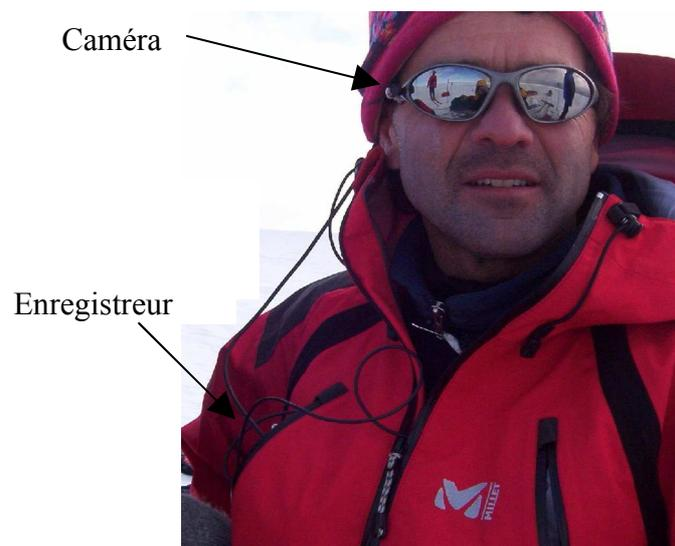
Installation du dispositif d'enregistrement embarqué
