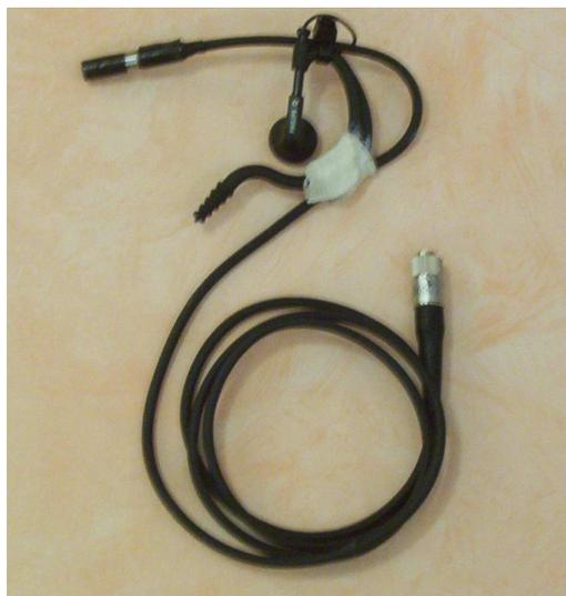
Caméra couleur cylindrique à objectif déporté : L25mm, Ø7mm, 40g
