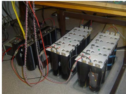
**Figure IV-18 : Bancs de condensateurs utilisés pour émuler l'état de charge des batteries**
