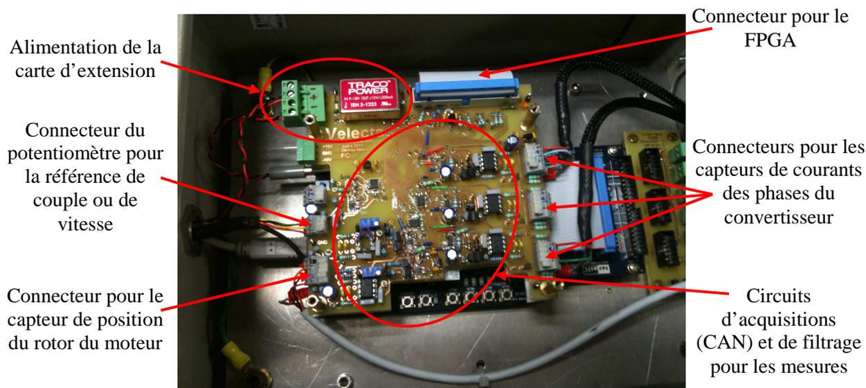
Figure IV-6 : Carte de mesure pour la commande du moteur
