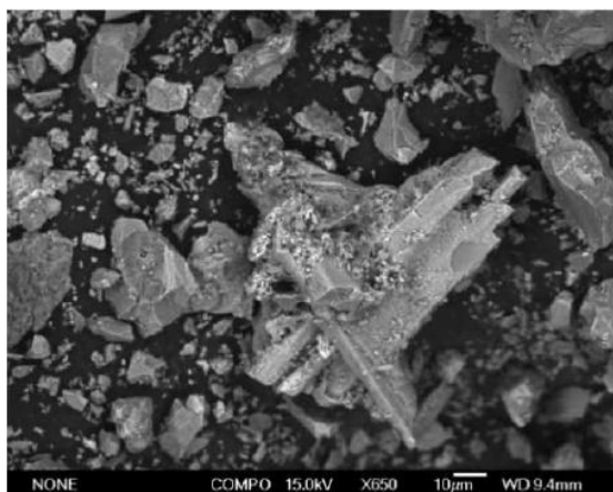
Figure 16 : Image MEB d'oxy-hydroxydes de fer riches en phosphore à la surface d'un oxyde de fer présent sur un laitier "melter" (Pratt et al. , 2010)
