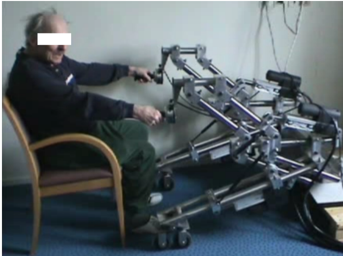
FIG. 1.13 – Interface Robotique DINO en utilisation avec une personne âgée pour la verticalisation.
