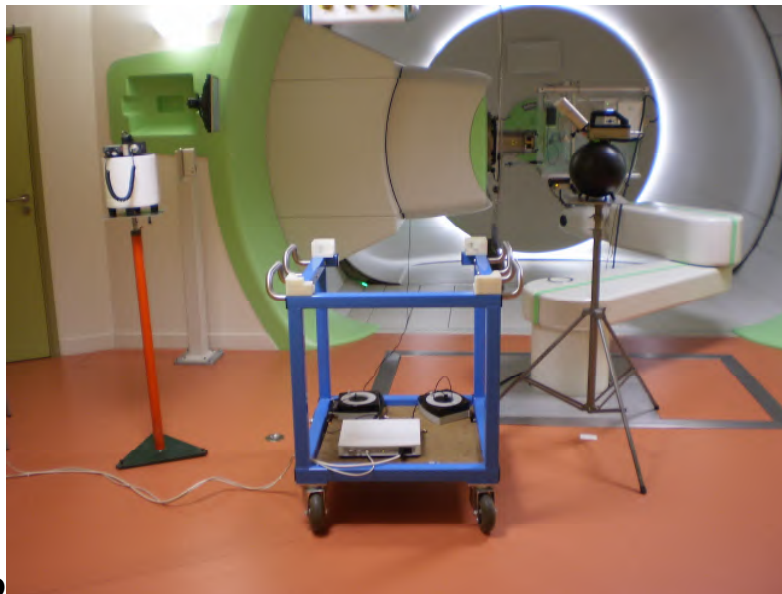
Figure IV.7- Visualisation des instruments de mesures de H^*(10) dans la salle de traitement à différentes positions: a) le WENDI-2 placée à la position 4 et le CPET Hawk à la position 5, b) le Berthold LB 6411 placé à la position 3 et le WENDI-2 à la position 1.
