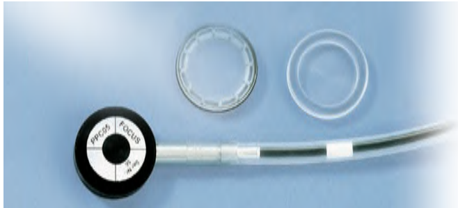
Figure III.1- Chambre d'ionisation plane parallèle PPC05 fabriquée par IBA. Elle a été utilisée pour les mesures de profils de dose en profondeur à l'ICPO (figure adaptée de IBA, 2007).
