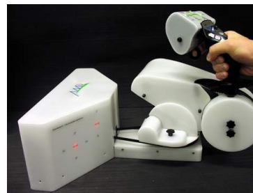
(b) Interface haptique HIMiC, université d'Oldenbourg [Fatikow 03]
