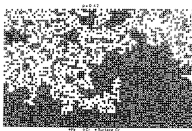
Figure I-12 Résultat d'une simulation 2D du modèle de percolation La surface du modèle est en haut de la figure
