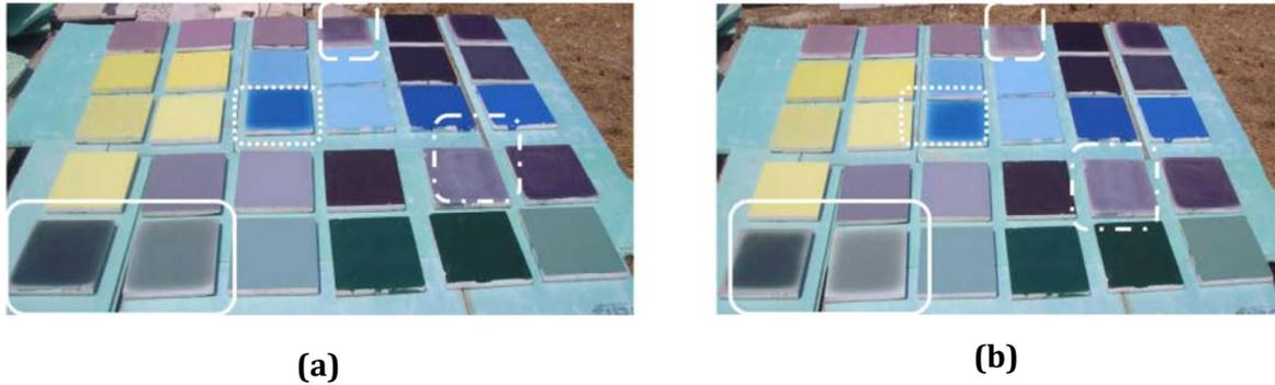
**Figure I. 15** Les phases de changement de couleur des revêtements thermo-chromiques. **(a)** L'état coloré au-dessous de 30°C. **(b)** le début de l'éclaircissement des couleurs au-dessus de 30°C (Karlessi *et al.*, 2009).
