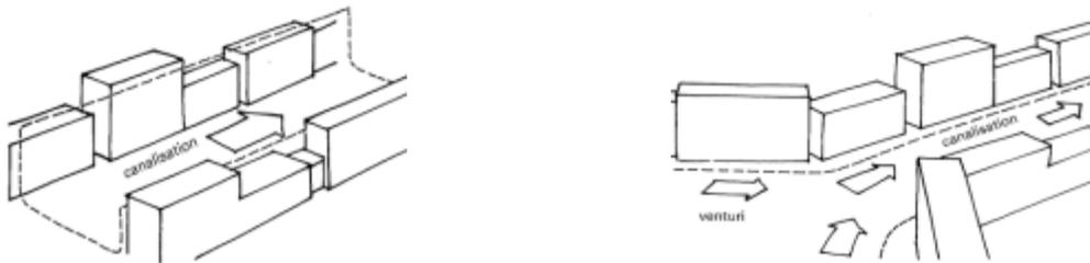
**Figure I. 22** A gauche : Canalisation du vent par la direction de la rue. A droite : Présentation d'une anomalie aérodynamique "canalisation-Venturi" (**Gandemer, 1976**).
