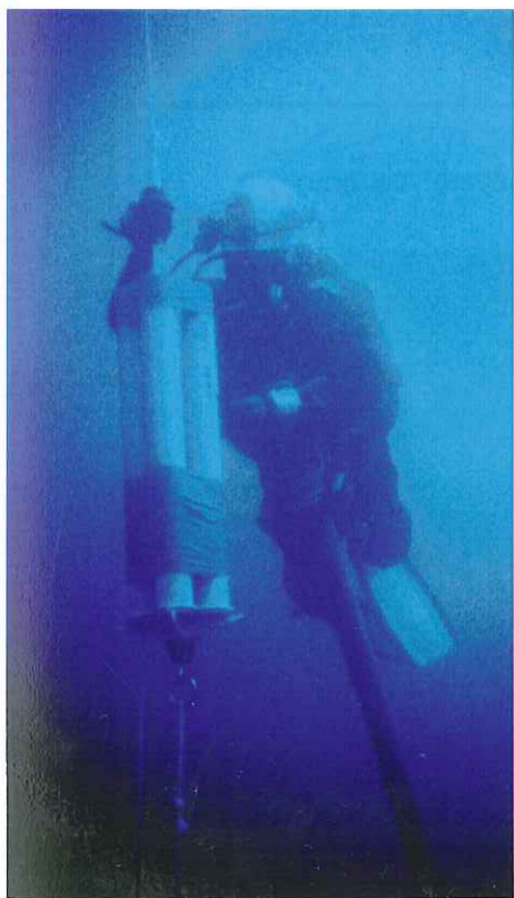
Figure III-10 : Technique de prélèvement par trappe à sédiment "hors-gel"
