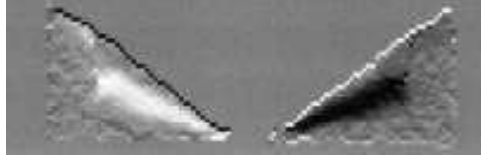
FIG. B.8 – Image du taux de cisaillement local obtenue par résonance magnétique nucléaire sur une solution de CPCl–NaSal. Le taux de cisaillement est codé en niveaux de gris arbitraire. Figure extraite de la référence [59].
