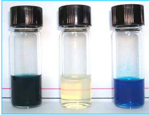
Figure IV-6 : Photographie de solutions de nano-émulsions : de gauche à droite, nano-émulsions dopées DiR, non dopées et dopées DiD.
