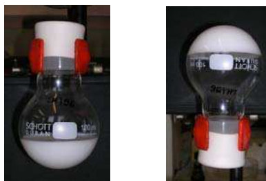
Figure 90 – Aspect du produit final de LH196, polymérisation du méthacrylate de méthyle dans l'isododécane à 80°C en présence du stabilisant PA2EH 51 -b-PAMe 56 -b-PA2EH 51 à 3 wt%.
