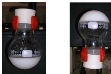
Figure 90 – Aspect du produit final de LH196, polymérisation du méthacrylate de méthyle dans l'isododécane à 80°C en présence du stabilisant PA2EH<sub>51</sub>-b-PAMe<sub>56</sub>-b-PA2EH<sub>51</sub> à 3 wt%.
