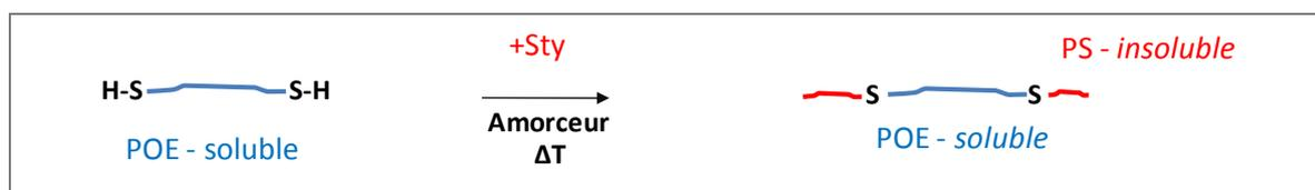
Figure 9 – Formation de copolymères à blocs à partir d'un macroagent de transfert.
