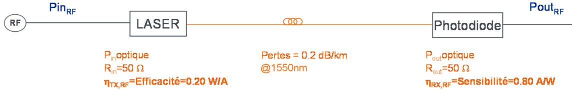
FIG. 3.1 – Principales caractéristiques d'une transmission radio sur fibre
