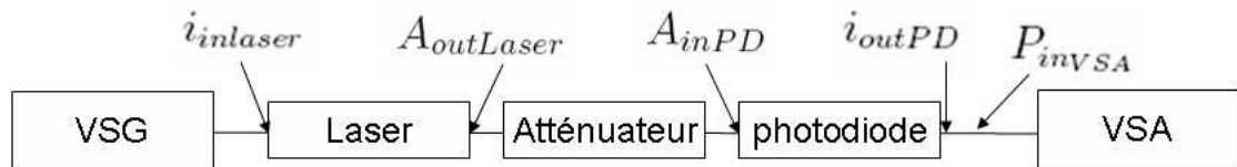
FIG. 4.25 – Schéma représentant les valeurs mesurées ou calculées pour obtenir les coefficients A_1 et A_3
