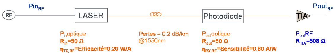
FIG. 3.2 – Principales caractéristiques d'une liaison radio sur fibre avec un amplificateur transimpédance
