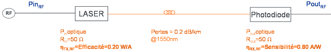
FIG. 3.1 – Principales caractéristiques d'une transmission radio sur fibre
