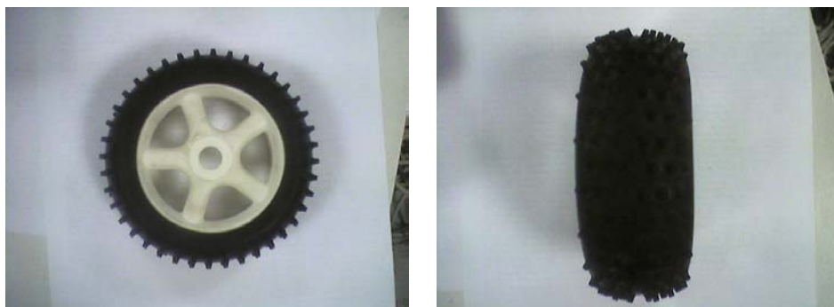
FIG. 5.3 – Détail d'une roue déformable
