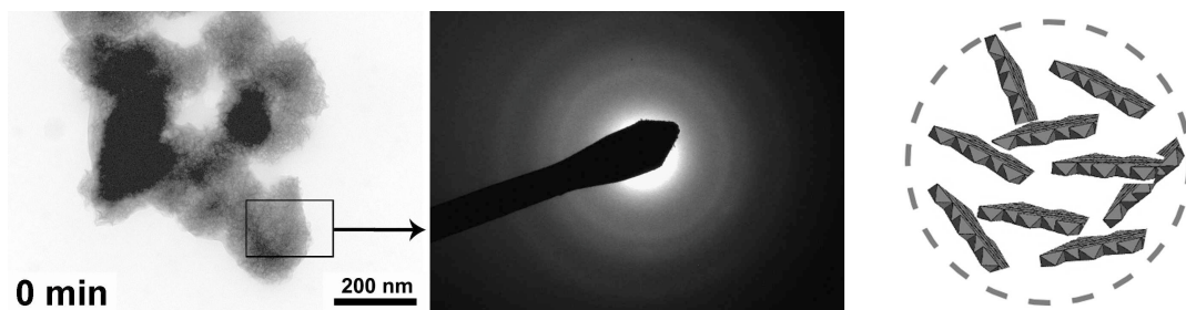
FIG. 2.17 – Clichés TEM, SAED et schéma de la structure supposée du composé initial obtenu par médiamutation en milieu initial acide.
