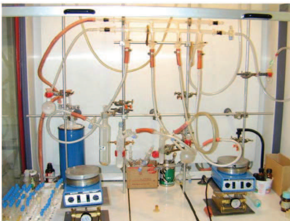
Figure 1 : Rampe à vide et verrerie pour le travail sous atmosphère inerte
