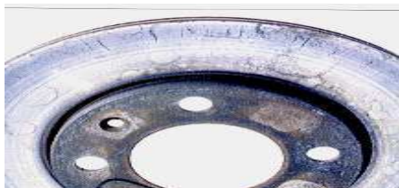
Fig. I.24 : Faïençage sur les pistes de frottement
