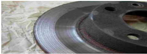
Fig. I.30 : Usure des pistes
