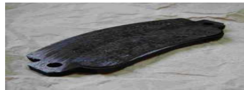
Fig. I.33 : Usure excessive des plaquettes
