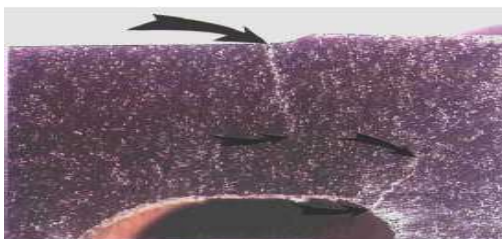
Fig. I.28 : Section de disque fissuré
