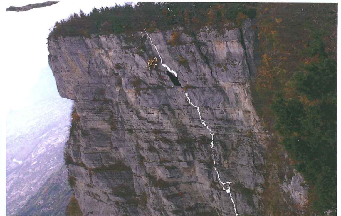
FIG. 3.11 – Intersection d'un plan de fracture avec la paroi.
