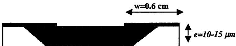
**Figure 4.20** Zone de mesure de la résistance dans une configuration co-planaire<sup>253</sup>
