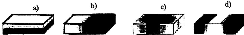
Figura 1.16 Rappresentazione schematica della variazione di struttura di un FGM a) in direzione longitudinale b) in direzione trasversale c) concentricamente d) dal centro verso le superfici esterne<sup>4</sup>
