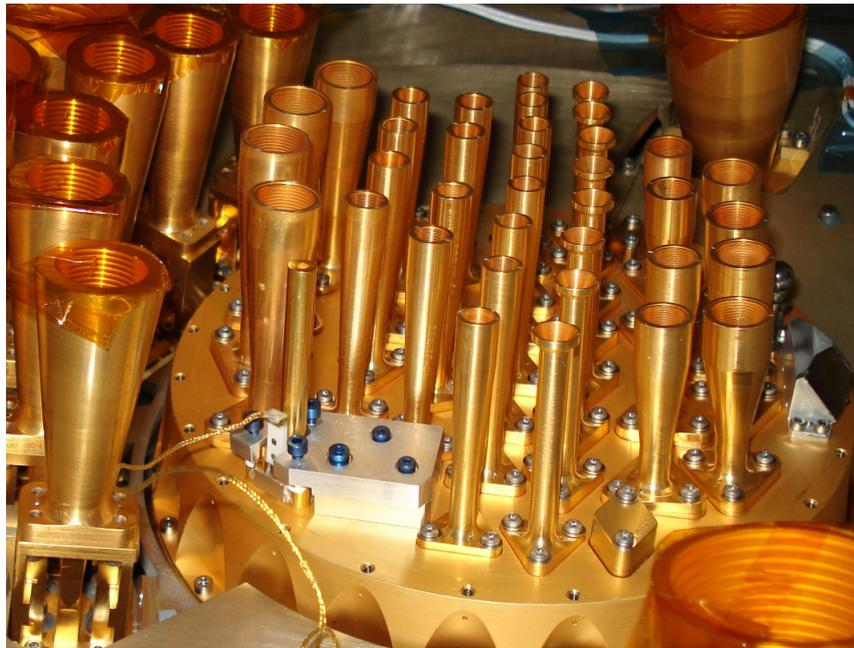
FIGURE 7.7 – Photographie du plan focal de l'instrument HFI. On voit également quelques guides d'onde de LFI. Crédit : ESA / Planck HFI-LFI consortium. [Lamarre 2010]
