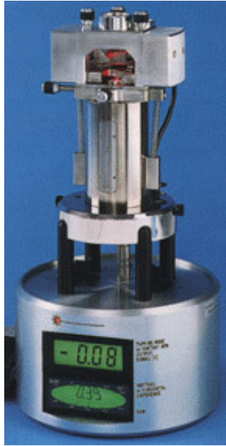
FIG. 3.4 – Microscope à champ proche utilisé au laboratoire : Nanoscope IIIa de Digital Instrument. Hauteur : 30cm
