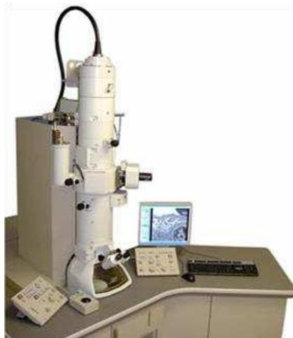
**Figure 1 :** Photographie du dispositif expérimental de microscopie électronique en transmission au sein de la plateforme Imagif : microscope électronique en transmission de 120 kV JEOL 1400
