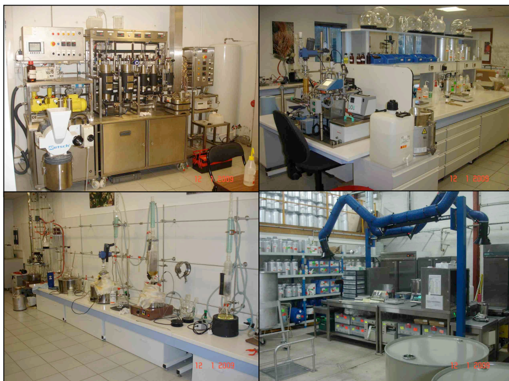
Photo 93 (haut, g.) – Extracteur au CO2 supercritique Photo 94 (haut, d.) – laboratoire d'analyse pureté Photo 95 (bas, g.) – unité de distillation expérimentale Photo 96 (bas, d.) – unité de préparation de commandes © 2009 RM
