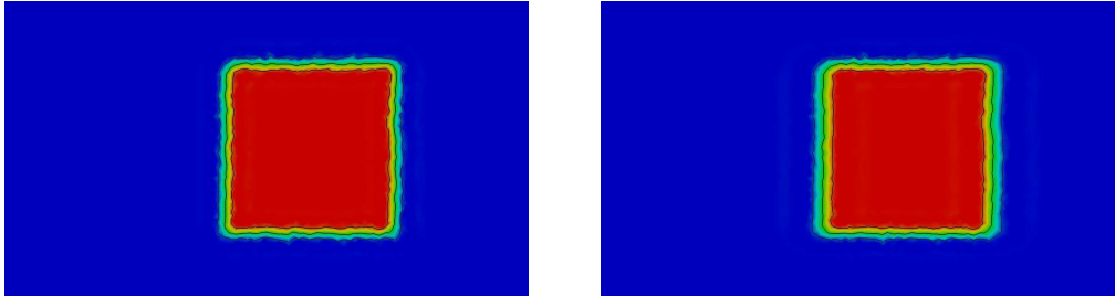
FIGURE 2.19 – Solution zoomée et courbes de niveau de 0.1, 0.5, 0.9 pour k = 2 avec une CFL de 0.5 (gauche) et 10 (droite)
