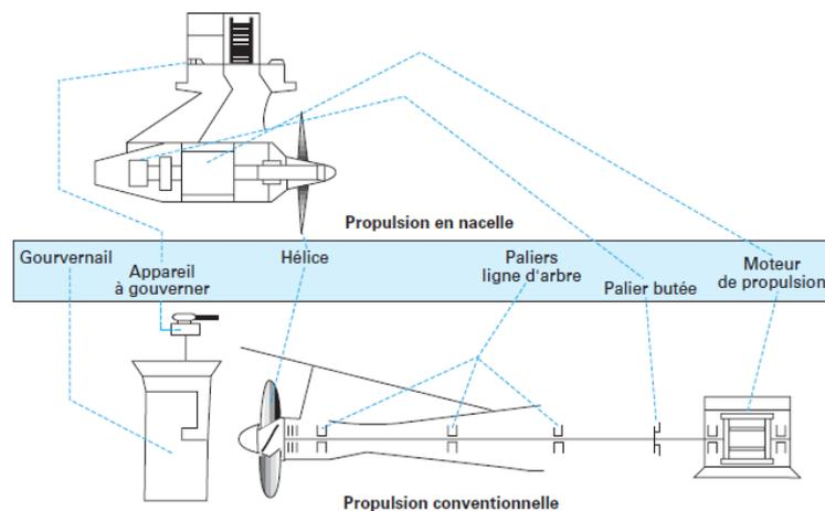
**Figure I.2 :** Principaux éléments du système de propulsion navale [Fil-00].
