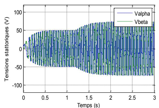
(f) Tensions statoriques  $v_{\alpha\_ref}$ ,  $v_{\beta\_ref}$  (V).
