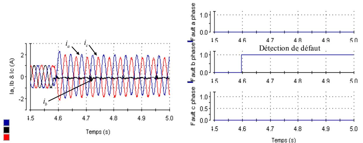
(a) Courants statoriques  $i_a$ ,  $i_b$  et  $i_c$  en présence de défaut d'ouverture de la phase  $b$ .
