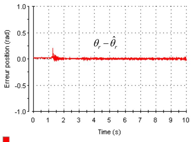
(d) Erreur d'estimation ( $\theta_r - \hat{\theta}_r$ ), transistor  $T_1$
