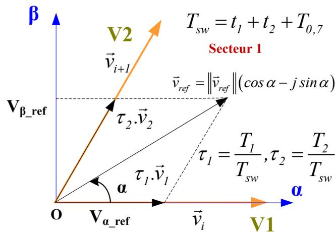
**Figure II.8 :** Principe d'application d'un vecteur de référence.
