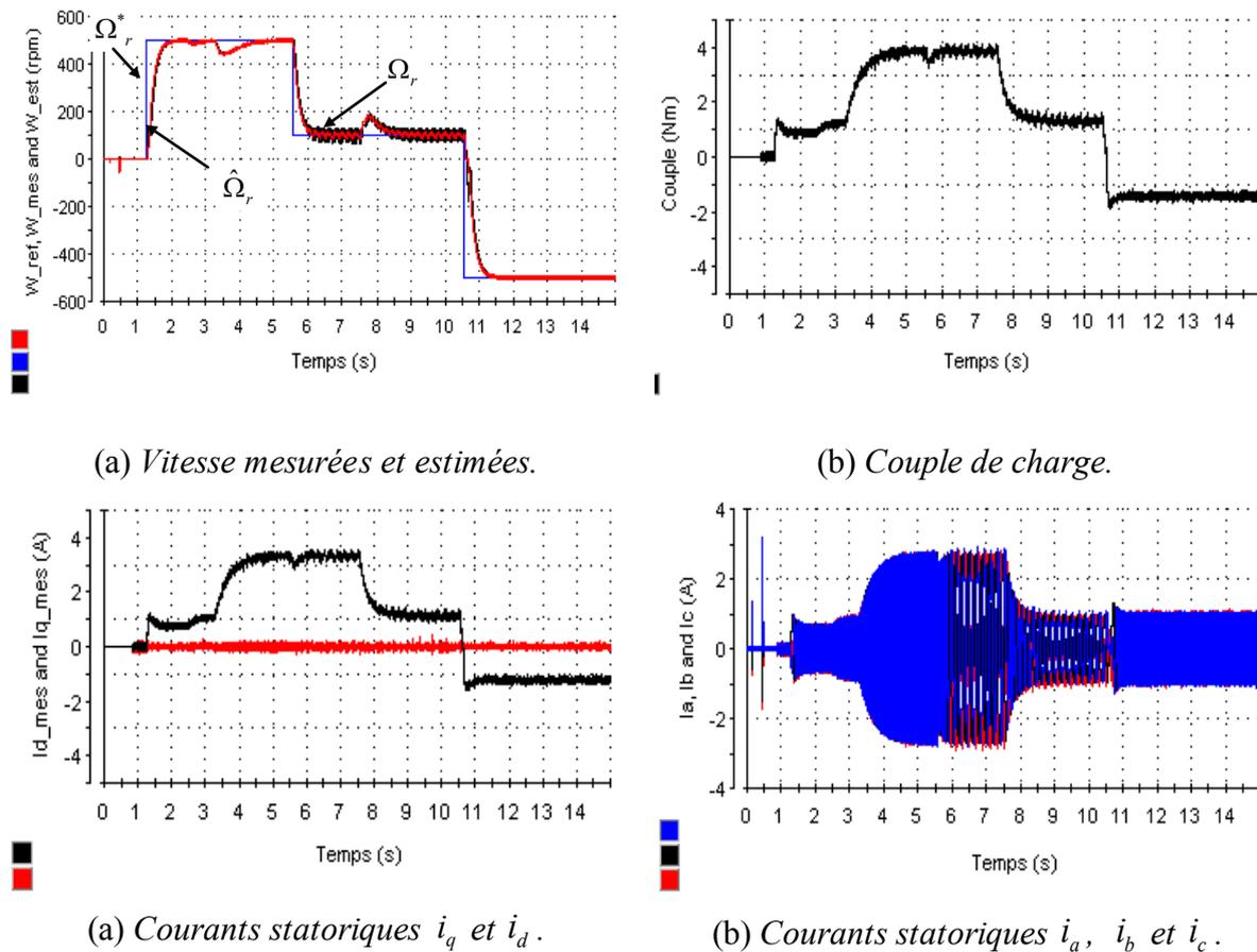
**Figure IV.30:** Résultats expérimentaux pour un profil de vitesse: de l'arrêt à 500 tr/min à 100 tr/min, puis à -500 tr/min avec l'application du couple de charge nominal.
