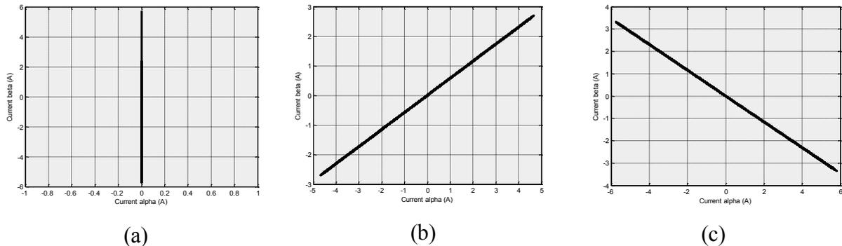
**Figure V.9:** Représentation bidimensionnelle des courants statoriques
