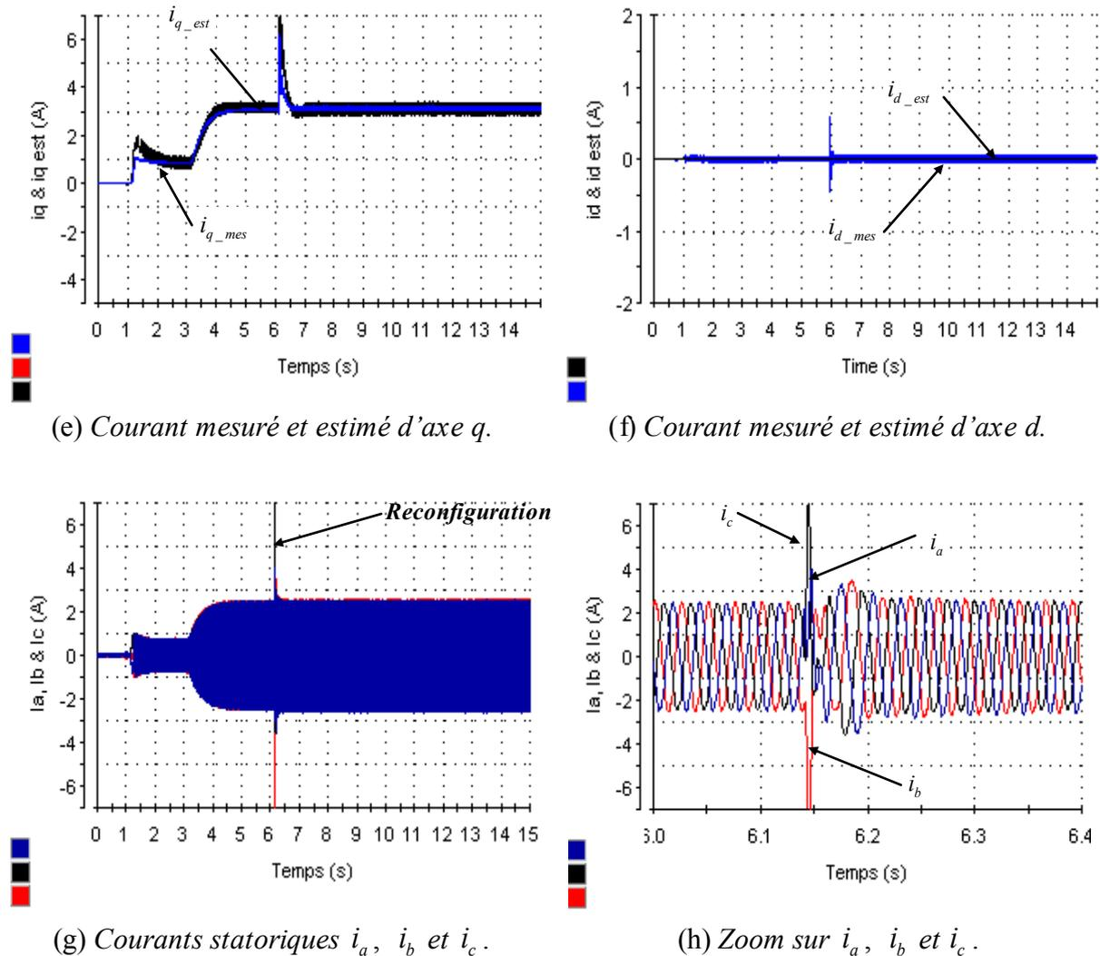
**Figure V.26 :** Reconfiguration de la commande vectorielle suite au défaut du capteur mécanique du MSAP pour une vitesse de 800 tr/mn, avec un couple de charge de 4 Nm (estimation de la vitesse par la méthode MRAS).
