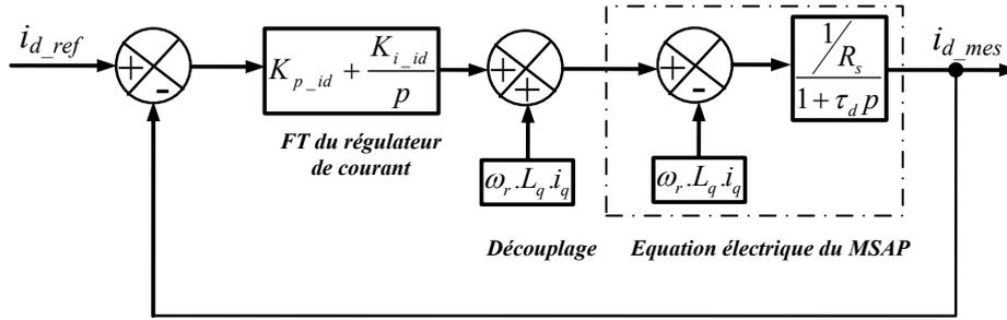
Figure III.1 : Boucle de régulation du courant d'axe direct.
