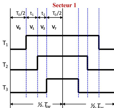
Figure II.10 : Séquences des signaux de commande.
