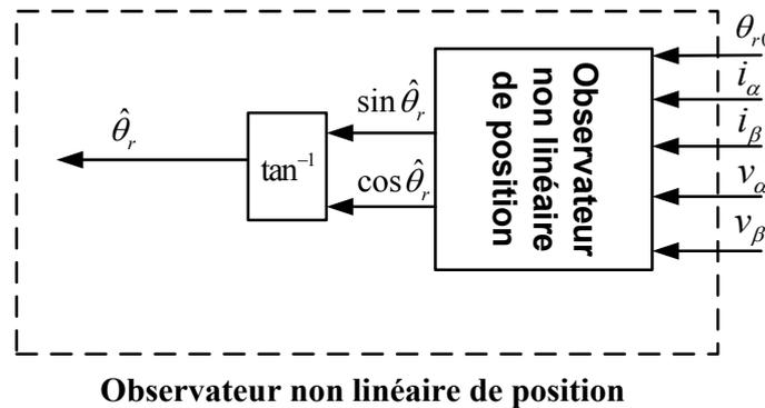
Figure IV.24: Estimation de la position électrique par l'observateur non linéaire.
