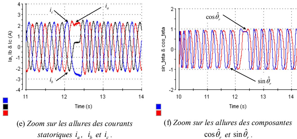
**Figure V.28 :** Reconfiguration de la commande vectorielle suite au défaut du capteur mécanique du MSAP pour un cycle de vitesse de 800 et 60 tr/mn, avec un couple de charge de 3 Nm (estimation de la vitesse par l'observateur non linéaire).
