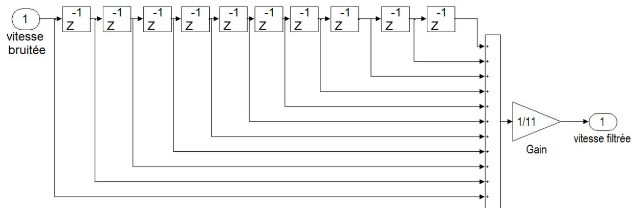
*Figure III.11: Schéma bloc du filtre numérique de vitesse.*
