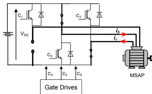
**Figure A.4:** Mesure de la constante de temps électrique transversale.
