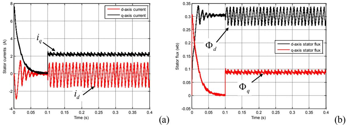
**Figure V.3:** Évolution temporelle des courants et des flux en présence d'une rupture de la phase statorique : a) les courants statoriques  $i_d$  et  $i_q$ , b) les flux statoriques  $\Phi_d$  et  $\Phi_q$ .
