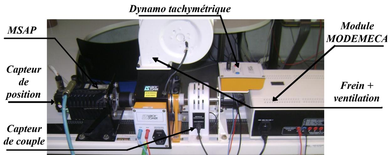
Figure III.10 : Partie mécanique de la plate forme expérimentale.
