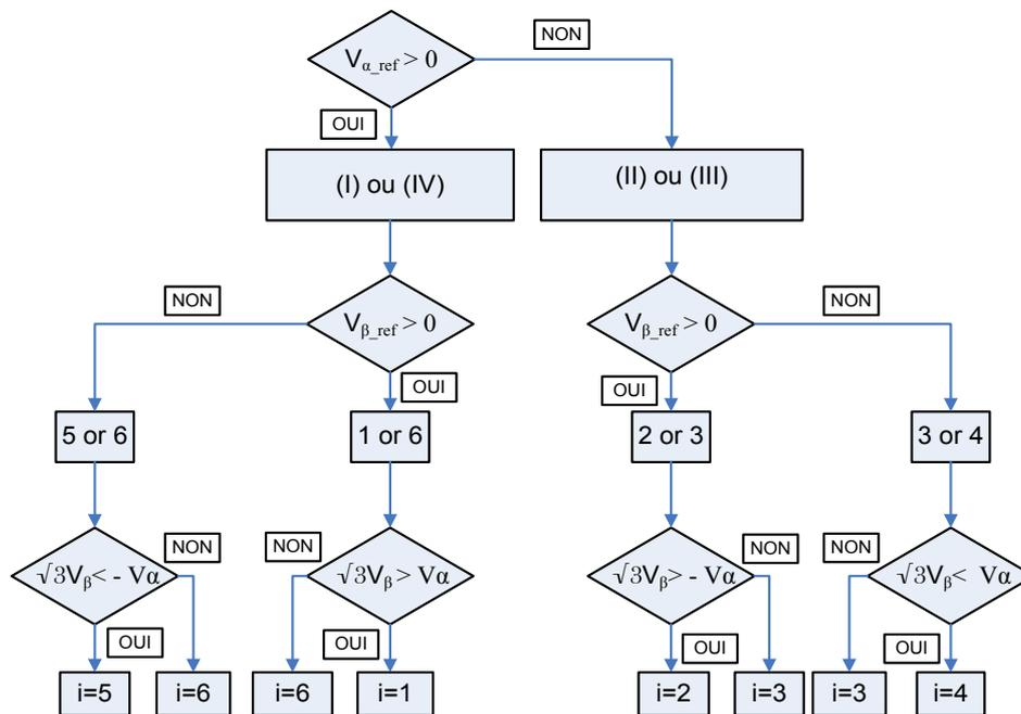
Figure II.11 : Algorithme de détermination du secteur.
