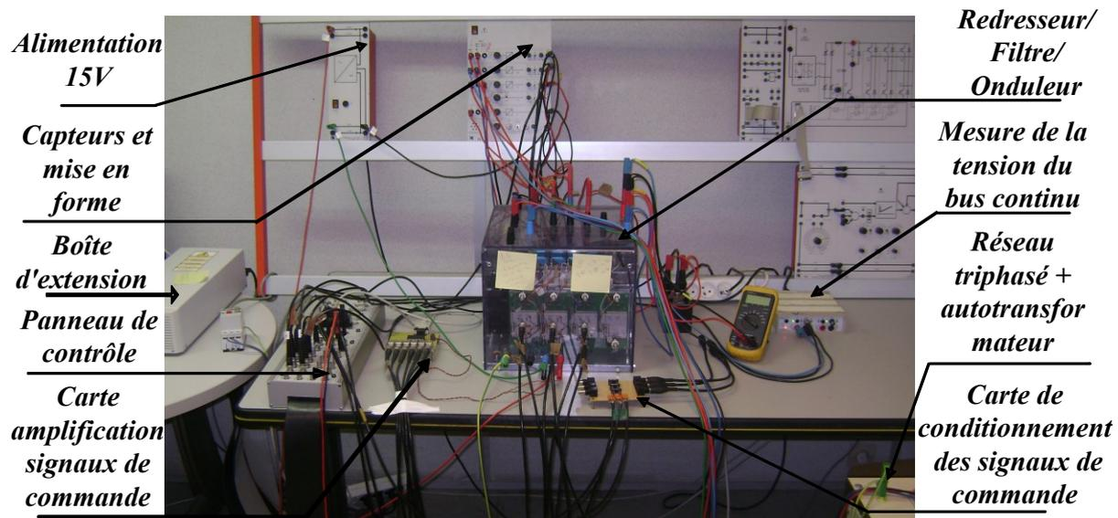
*Figure III.8 : Photo de la partie puissance et mesure.*
