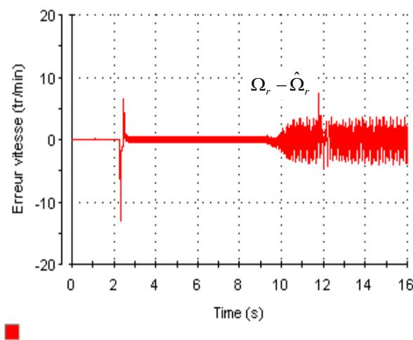
(c) Erreur sur la vitesse mécanique pour une vitesse de 60 tr/mn.
