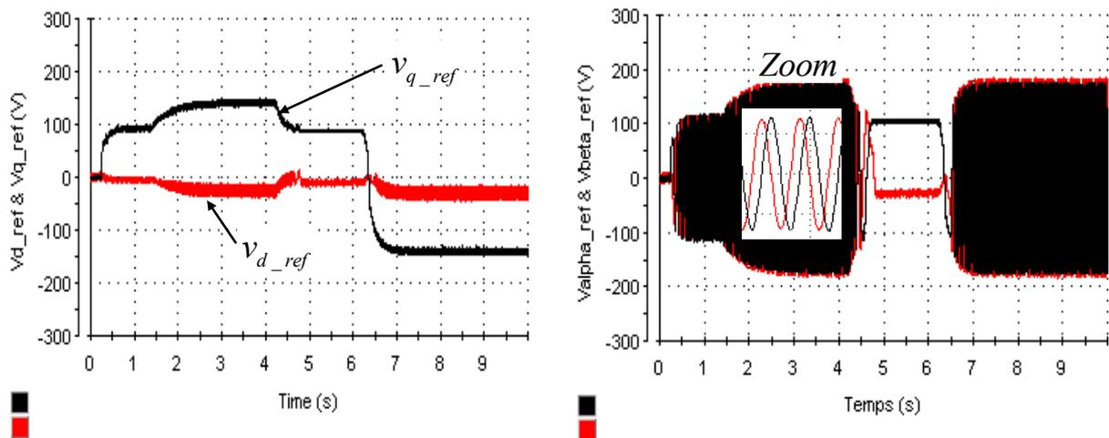
(b) Tensions statoriques  $v_{d\_ref}$  et  $v_{q\_ref}$  (V).(b) Tensions statoriques  $v_{\alpha\_ref}$  et  $v_{\beta\_ref}$  (V).**Figure III.22:** Résultats expérimentaux des tensions statoriques.
