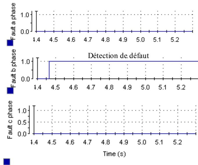
(c) Signaux de détection de défaut d'ouverture de la phase b.
