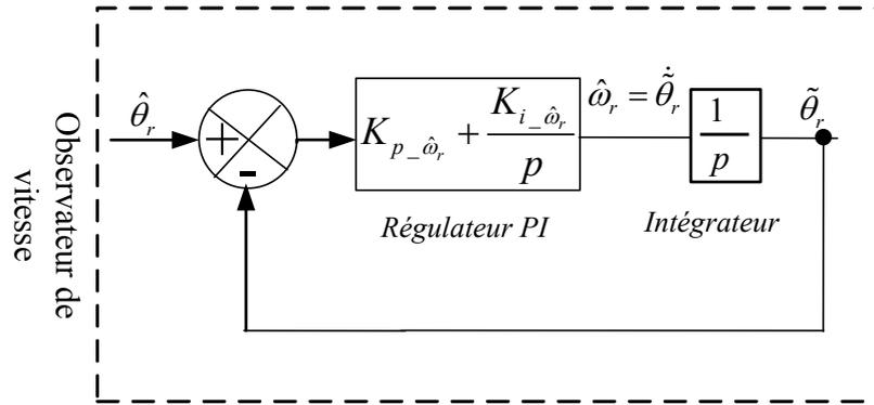
Figure IV.25 : Schéma du principe de l'observateur de vitesse.
