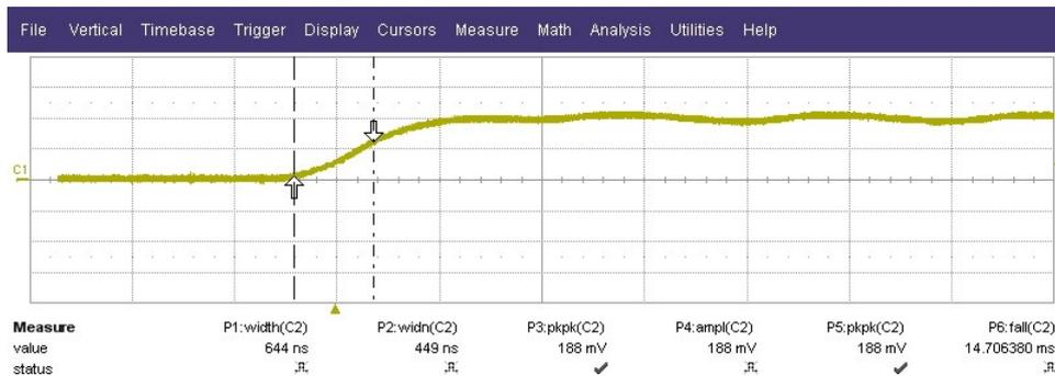
**Figure A.6:** Détermination de la constant de temps longitudinale.
