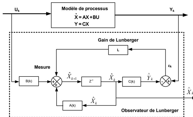
Figure I.12 : Schéma bloc de l'observateur de Luenberger [Gas-04].
