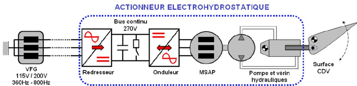
**Figure I.3 :** Système des actionneurs électro hydrauliques [Mav-07].
