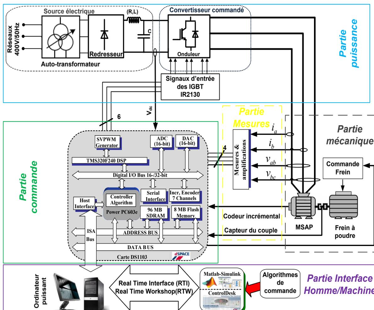
Figure III.7: Schéma du dispositif expérimental du banc d'essais.
