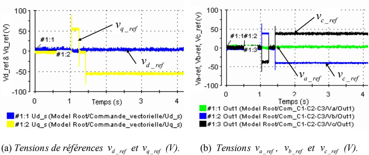
(a) Tensions de références  $v_{d\_ref}$  et  $v_{q\_ref}$  (V).(b) Tensions  $v_{a\_ref}$ ,  $v_{b\_ref}$  et  $v_{c\_ref}$  (V).**Figure III.16 :** Résultats expérimentaux des tensions de références pour une régulation de courant.
