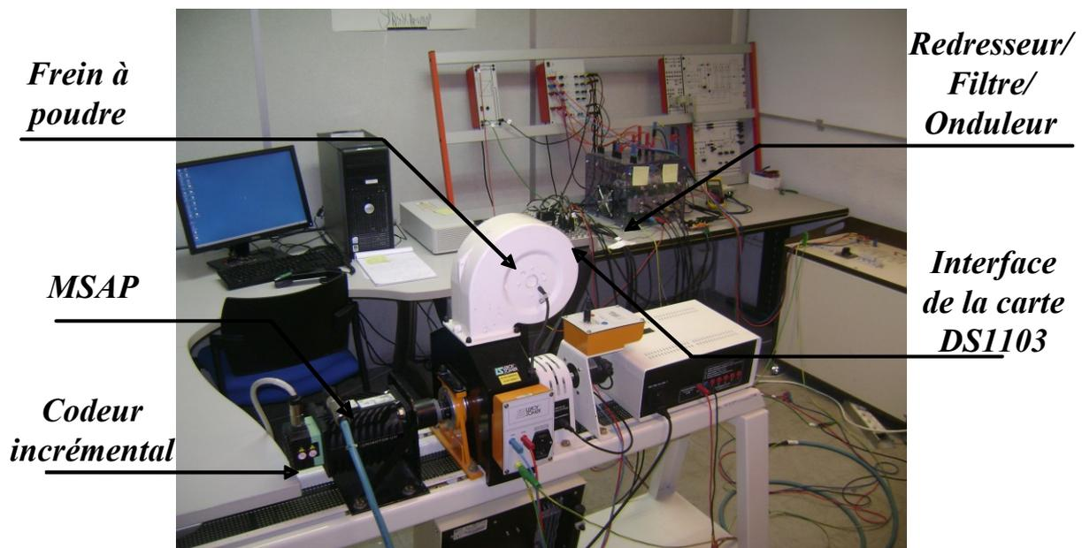
*Figure III.6: Vue d'ensemble du banc d'essais expérimental.*
