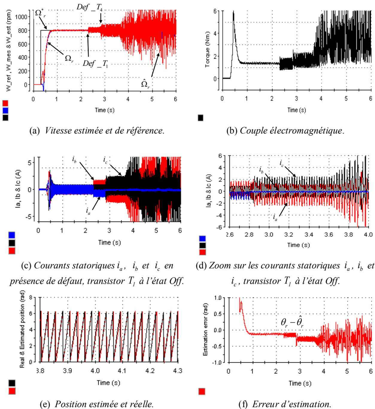
Figure V.19 : Évolution temporelle en fonctionnement sans capteur mécanique (par la
