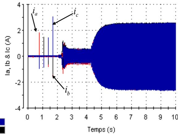
(g) Allures des courants statoriques mesurés  $i_a$ ,  $i_b$  et  $i_c$ .
