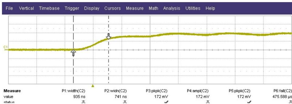
**Figure A.7 :** Détermination de la constant de temps transversale.
