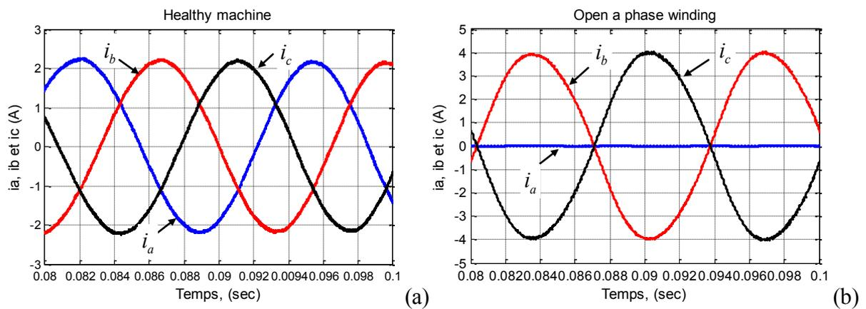
**Figure V.4:** Évolution temporelle des courants en présence d'une rupture de la phase statorique : a) sans défaut, b) en présence de défaut.
