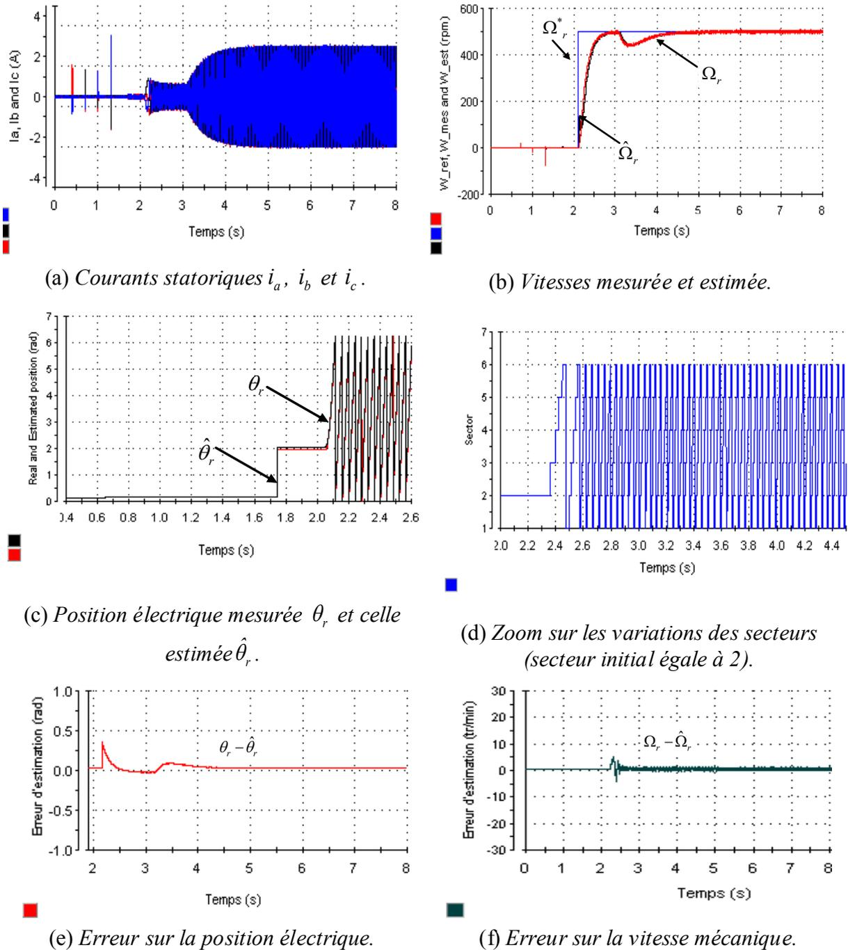
Figure IV.31: Démarrage du moteur pour une condition initiale non nulle.
