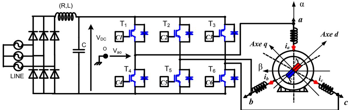
*Figure II.6 : Configuration de l'association convertisseur MSAP.*
