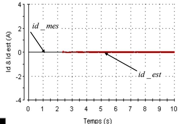
(d) Allures des courants mesuré et estimé d'axe d.
