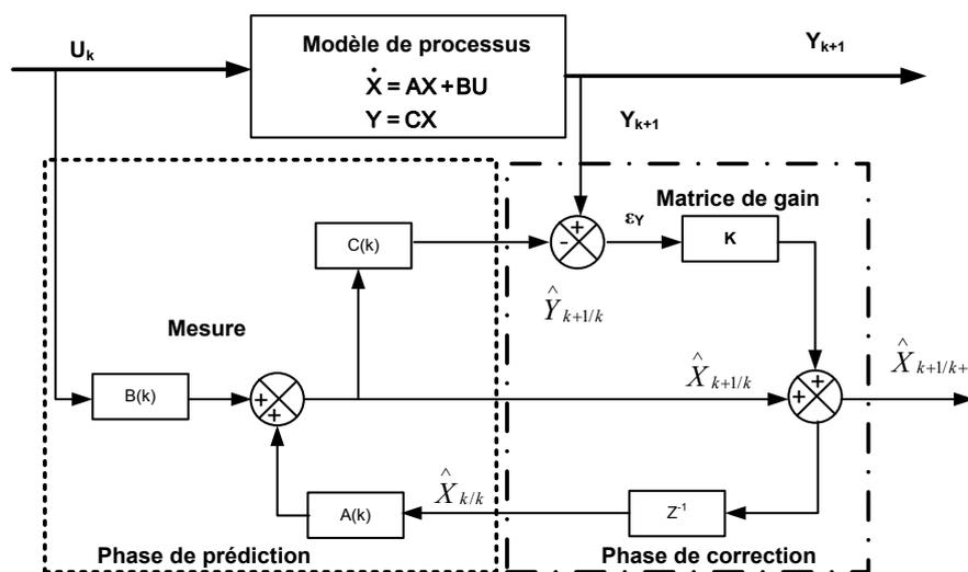
Figure 1.11 : Schéma de principe du filtre de Kalman.
