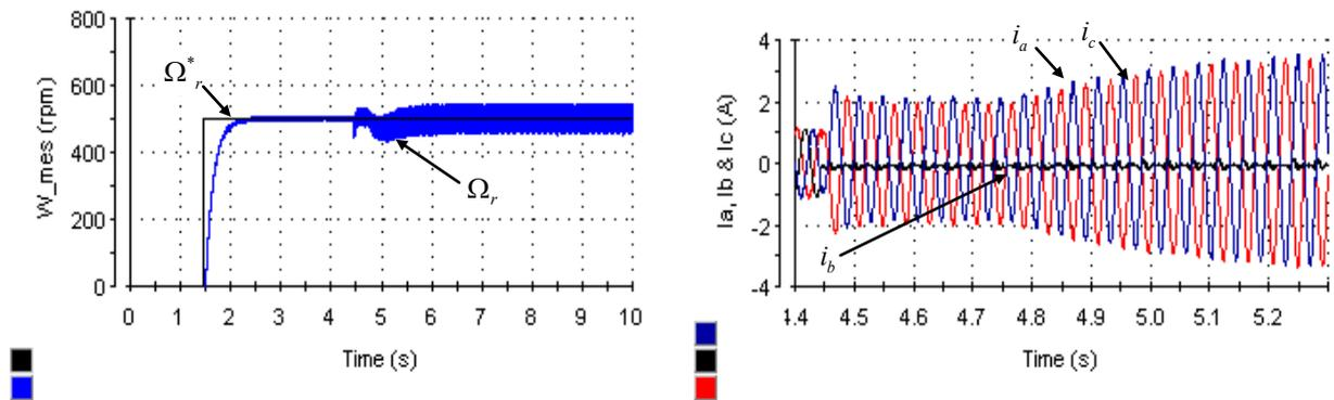
(a) Vitesse mesurée et de référence avec augmentation du couple de charge.
