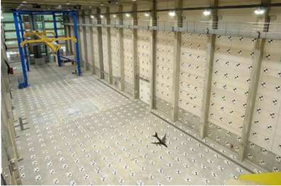
FIG. 3.1 – Catapultage d’une maquette d’avion de transport au banc B20
