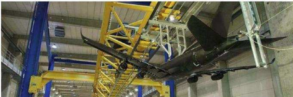
FIG. 3.5 – Maquette d’Airbus A340 disposée sur la rampe de catapultage
