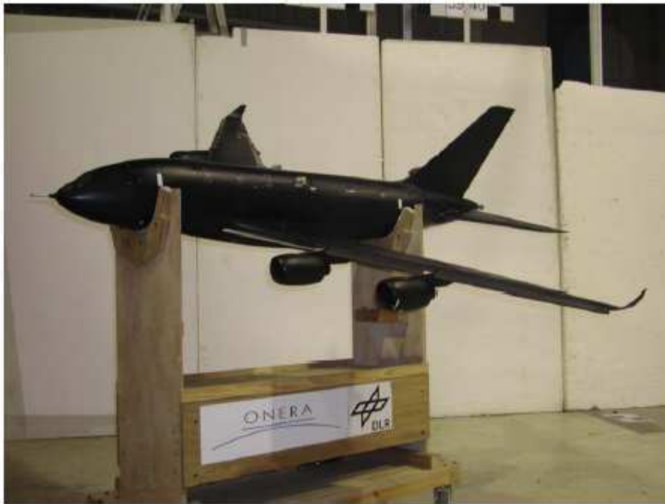
FIG. 3.7 – Maquette VLTA de référence (Airbus A380) utilisée dans le programme AWIATOR
