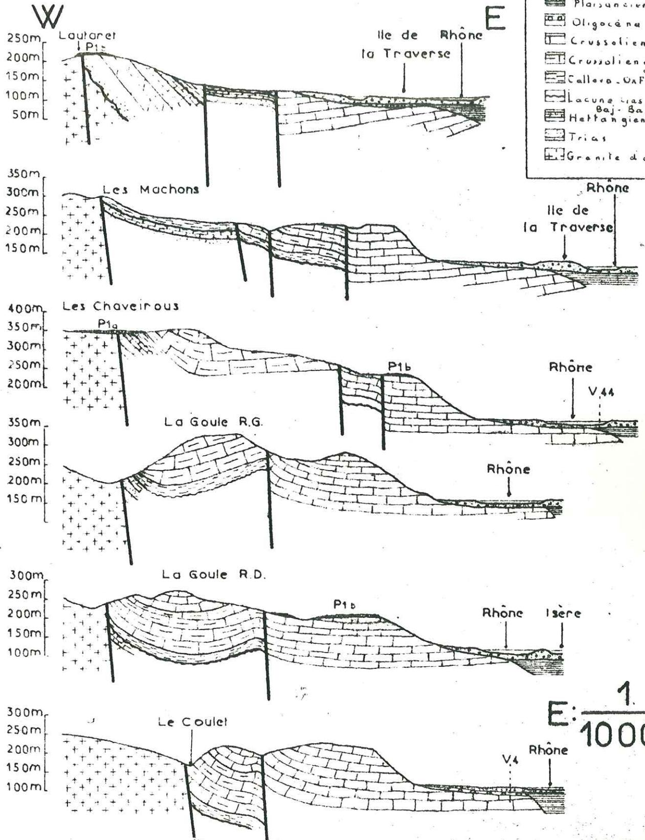
Après la faille des Mâchons, la terminaison nord de ce compartiment forme une sorte de cuvette dissymétrique dont le bord ouest est fortement redressé.
