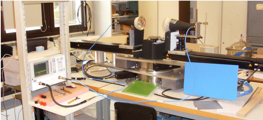
FIGURE 56 – Antennes focalisées et platines de déplacement micrométriques
