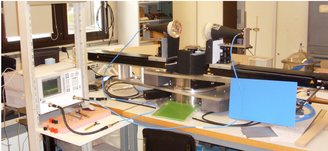
FIGURE 56 – Antennes focalisées et platines de déplacement micrométriques
