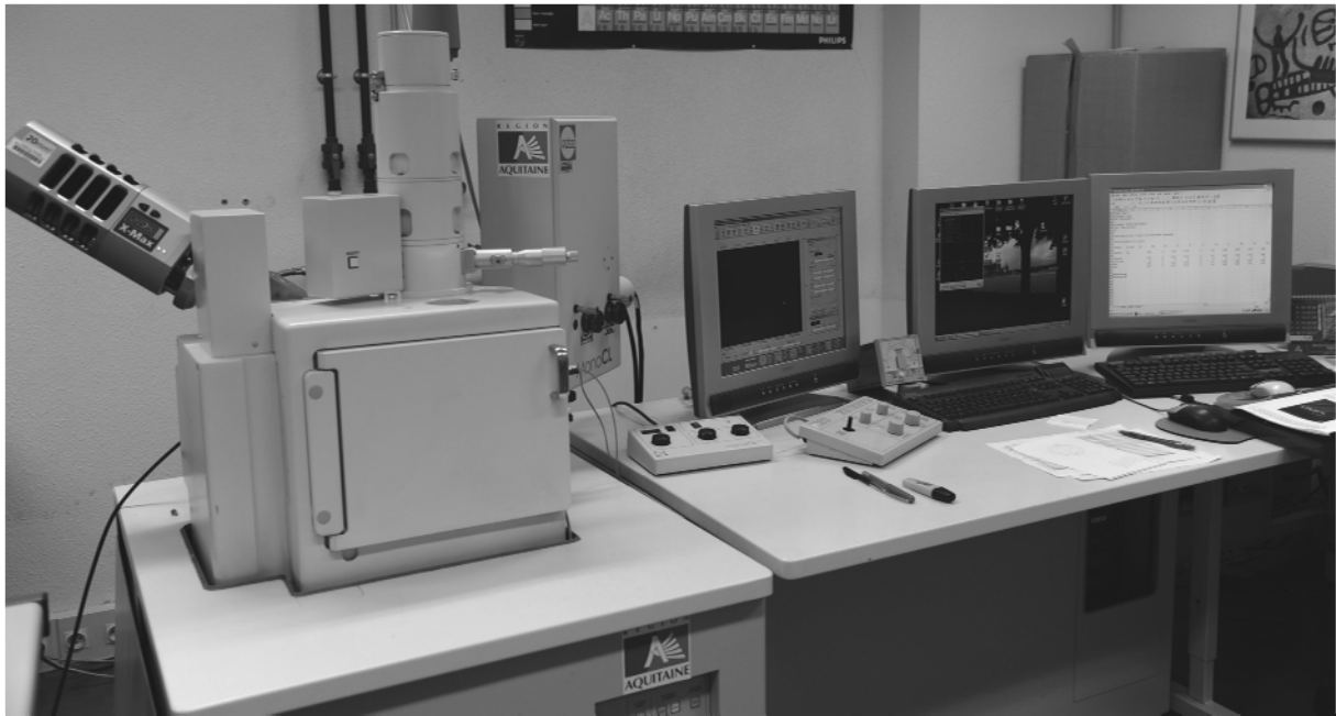
Figure 2 – Microscope électronique à balayage à pression variable utilisé au CRP2A et son système d'analyse EDXS.
