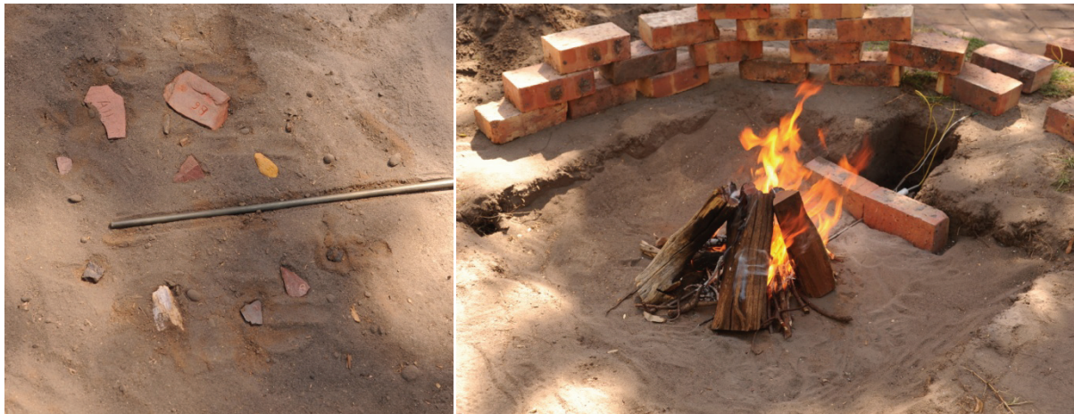
Figure 48 – Disposition des pièces d’ocre et de thermocouple à l’aplomb du feu expérimental (ici surface), et vue du feu en fonctionnement.
