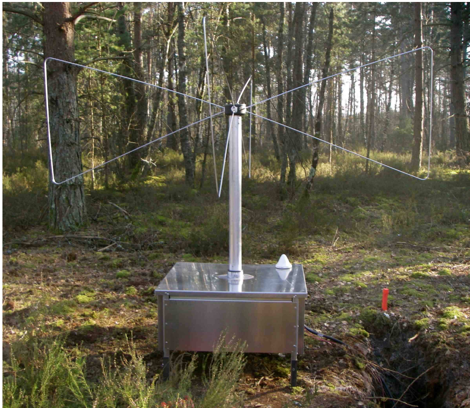
FIGURE 2.47 – Nouvelle antenne papillon double polarisation et son caisson-support dans lequel l'électronique est embarquée. Le cône blanc fixé dans un coin du caisson est le récepteur GPS.
