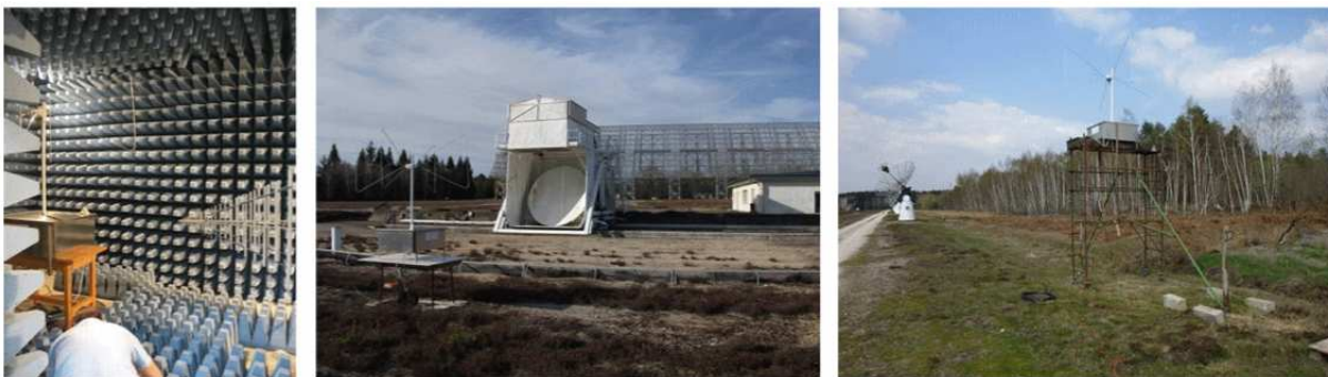
FIGURE 2.50 – Les trois tests de compatibilité électromagnétique réalisés en chambre anéchoïde (à gauche), au foyer du radiotélescope (au centre) et sur la ligne N-S du radiohéliographes (à droite)
