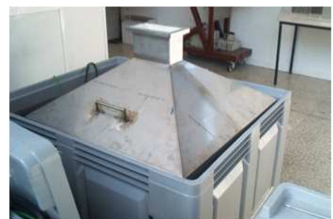
FIGURE 2.16 – Un scintillateur dans sa boîte en acier.
