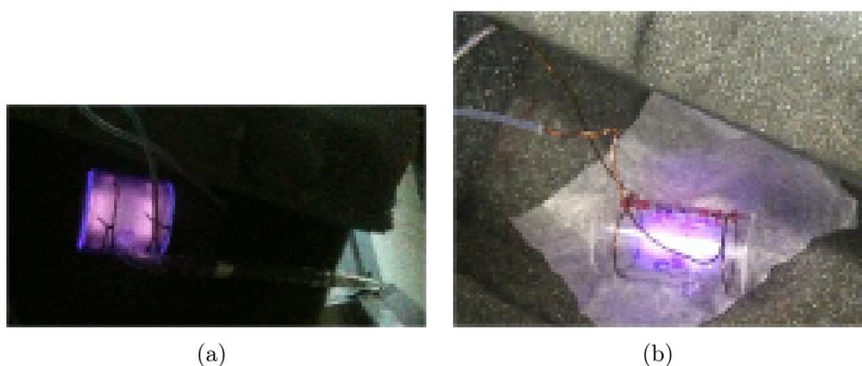
FIGURE 8.19 – Illumination du gaz tampon sous l'effet d'une décharge radio-fréquence dans une cellule de Cs. Les deux fils visibles forment deux électrodes en forme de boucle entre lesquelles une tension RF est appliquée.
