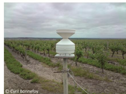
Pluviomètre à bascule (Mai 2009/Le Puy-Notre-Dame)
