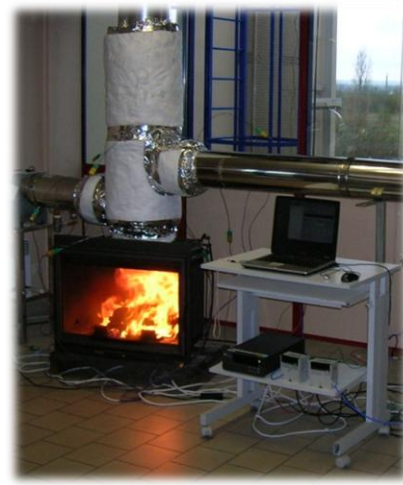
Conduit échangeur à plenums de diffusion
