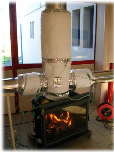
Conduit échangeur à chicanes
