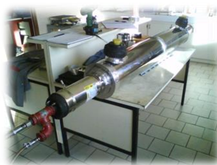
Figure 3.4 : Vue du test d'étanchéité mené au CERIC sur le prototype n°4 de CETP-NI
