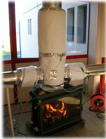
Conduit échangeur à chicanes
