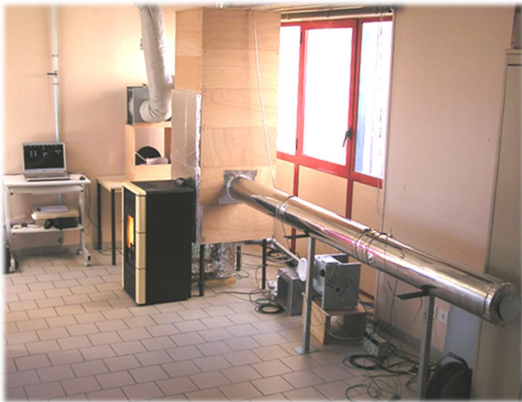
Figure 2.26 : Vue du banc de caractérisation thermique des prototypes de conduit échangeur
