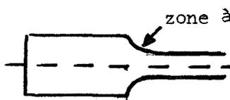
raccordement de deux arbres de diamètre différents.
