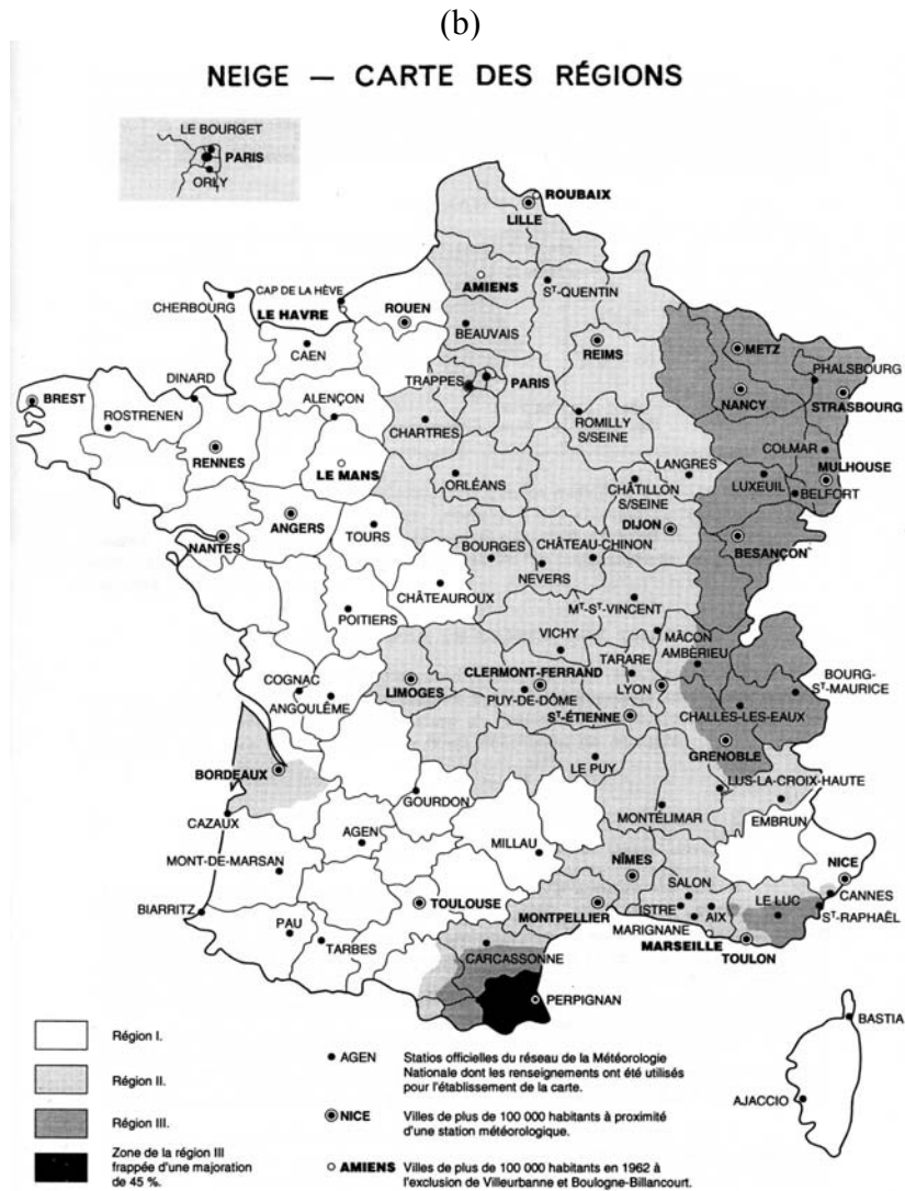
Figure 4.27. (a) Carte des régions de vent, (b) carte des régions de neige (NV65 1965).
