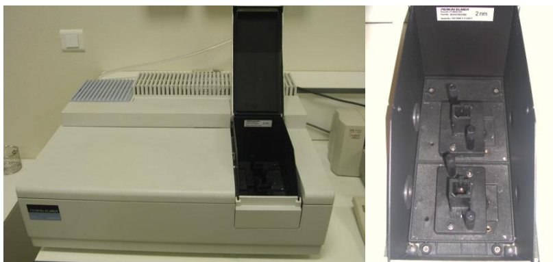
Figure II-8. Spectromètre UV-visible du département SGM de l'IUT de Saint Brieuc.
