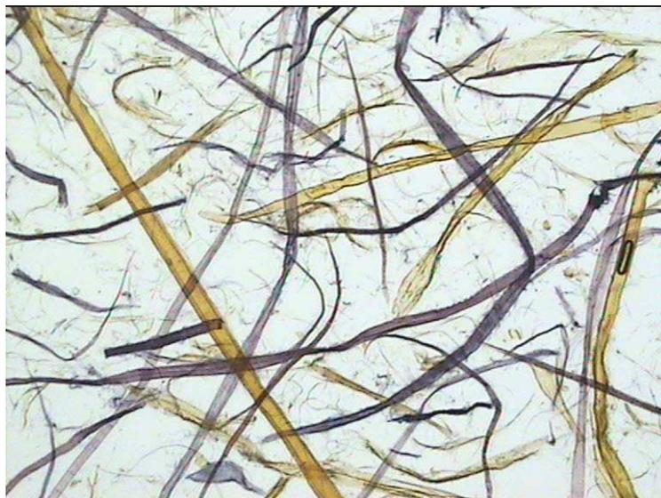
**Figure 4. Image au microscope d'une pâte. On observe les fibres et les fines en suspension [CTP].**
