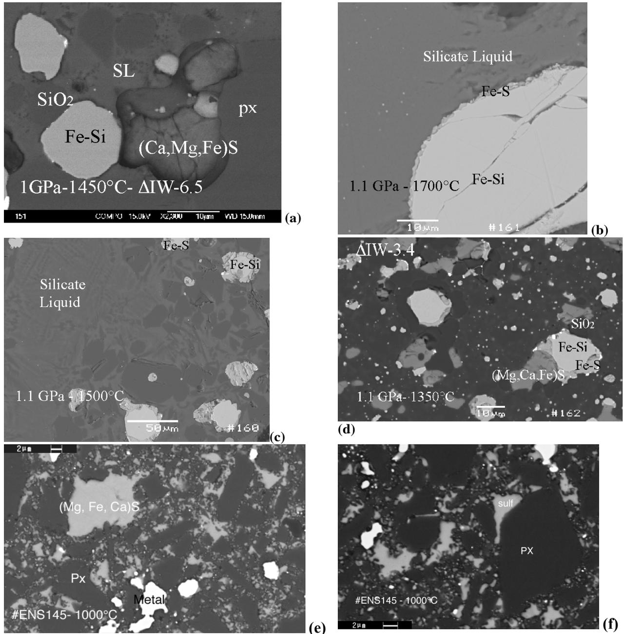
Figure 3.7: images MEB en électrons rétro diffusés de 5 échantillons de piston-cylindre obtenu vers 1GPa
