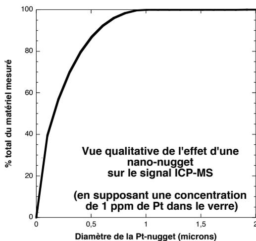
Figure 4.6: Graphe montrant l'importance du signal d'une nano-pépite de Pt, en fonction de son diamètre, sur un signal provenant d'un verre silicaté contenant 1 ppm de Pt, pour une vitesse d'ablation constante. On suppose que toute la nugget est prise en compte dans le signal.
