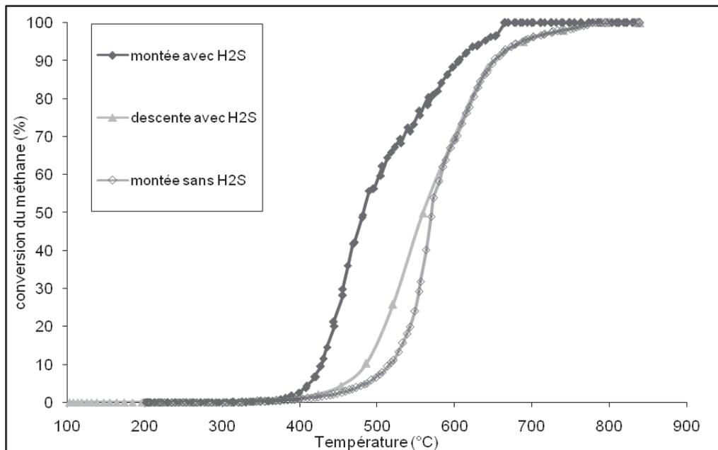
Figure 3 : activité catalytique en combustion du méthane, en absence et en présence de 35 ppm de H<sub>2</sub>S, de 2% Pt/Al<sub>2</sub>O<sub>3</sub> à l'état frais.
