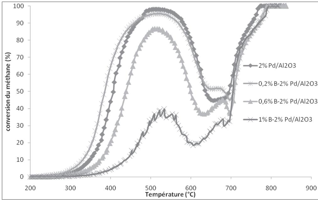
Figure 8 : conversion du méthane en fonction de la température pour les catalyseurs 2% Pd/Al<sub>2</sub>O<sub>3</sub> à l'état vieilli et x% B-2% Pd/Al<sub>2</sub>O<sub>3</sub> (0,2 ≤ x ≤ 1) lors de la descente
