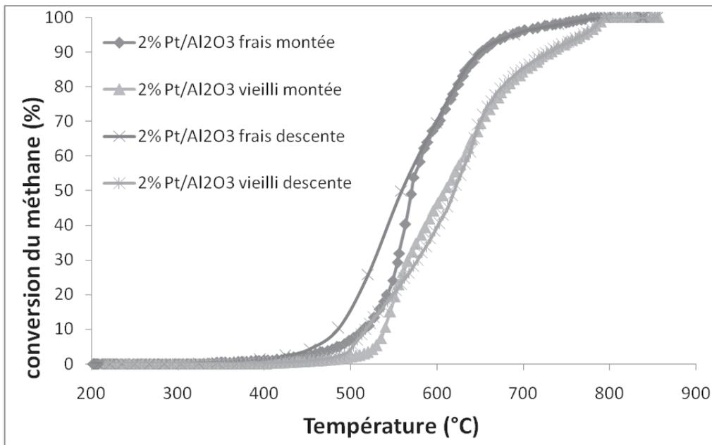
Figure 4 : conversion du méthane en fonction de la température pour le solide 2% Pt/Al<sub>2</sub>O<sub>3</sub> à l'état frais et à l'état vieilli
