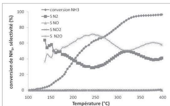
Figure 3 : conversion de l'ammoniac et sélectivité du catalyseur CuO-CuCr<sub>2</sub>O<sub>4</sub> commercial lavé avec du carbonate d'ammonium.
