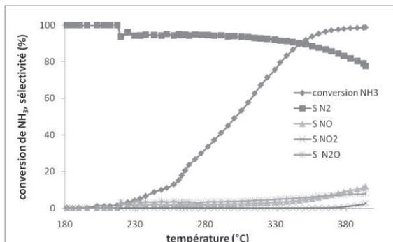
Figure 1 : conversion de l'ammoniac et sélectivité du catalyseur CuO/CuAl<sub>2</sub>O<sub>3</sub> préparé par la méthode « imp ».
