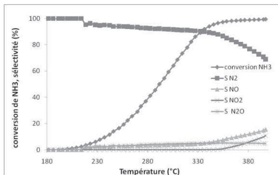
Figure 6 : conversion de l'ammoniac et sélectivité du catalyseur CuO/CuAl<sub>2</sub>O<sub>3</sub> préparé par la méthode « hydro Hy ».
