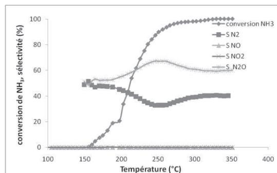
Figure 6 : conversion de l'ammoniac et sélectivité du catalyseur Mn-CuO-CuCr<sub>2</sub>O<sub>4</sub> préparé par le procédé sol gel.
