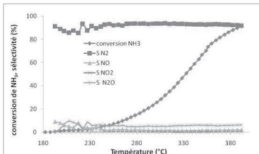
Figure 2 : conversion de l'ammoniac et sélectivité du catalyseur CuO/CuAl<sub>2</sub>O<sub>3</sub> préparé par la méthode « prop ».
