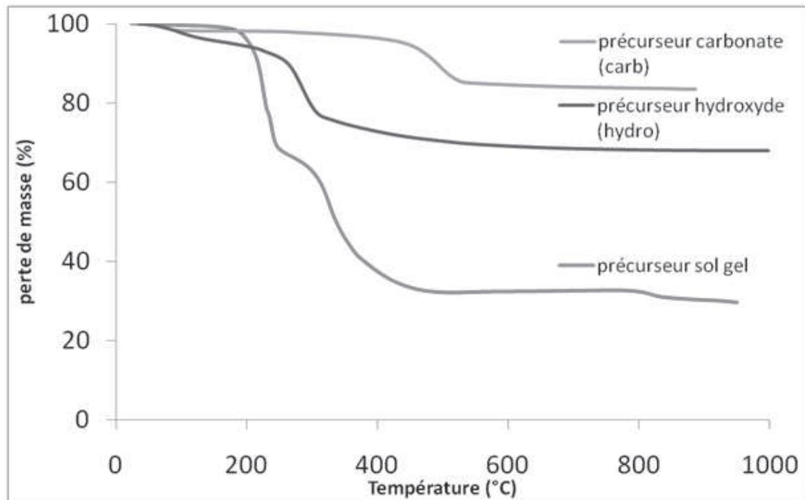
Figure 1 : ATG des précurseurs à base de cuivre-alumine
