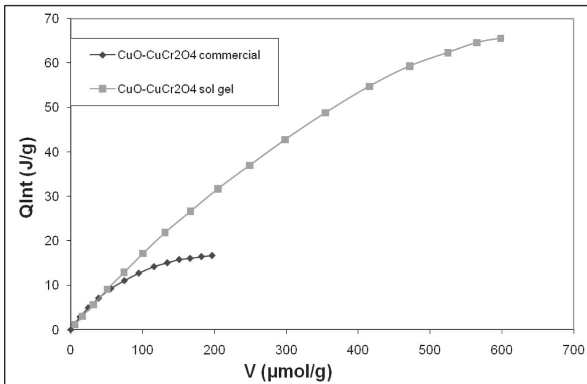
Figure 25 : représentation de l'isotherme calorimétrique d'adsorption de  $\text{NH}_3$
