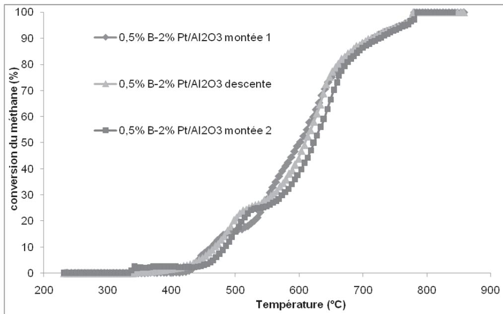
Figure 10 : activité catalytique en combustion du méthane du catalyseur 0,5% B-2% Pt/Al<sub>2</sub>O<sub>3</sub>
