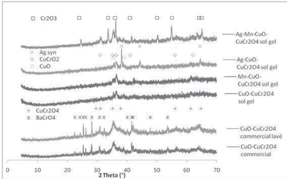
Figure 7 diffractogrammes des chromites de cuivre étudié  $\text{CuO-CuCr}_2\text{O}_4$
