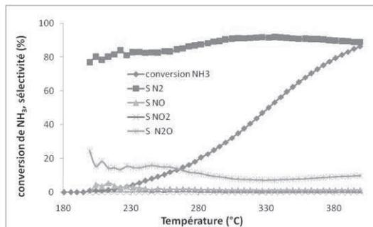
Figure 4 : conversion de l'ammoniac et sélectivité du catalyseur CuO/CuAl<sub>2</sub>O<sub>3</sub> préparé par la méthode « hydro ».
