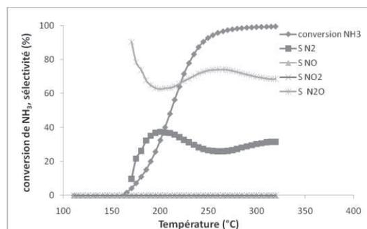
Figure 5 : conversion de l'ammoniac et sélectivité du catalyseur Ag-CuO-CuCr<sub>2</sub>O<sub>4</sub> préparé par le procédé sol gel.
