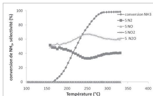
Figure 4 : conversion de l'ammoniac et sélectivité du catalyseur CuO-CuCr<sub>2</sub>O<sub>4</sub> préparé par le procédé sol gel.
