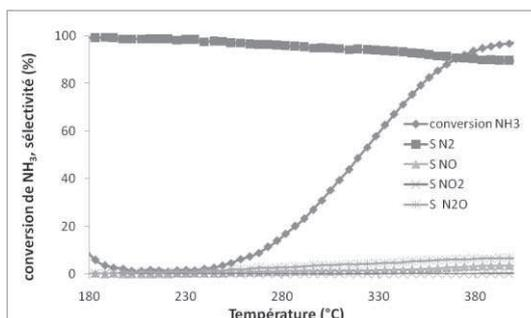
Figure 3 : conversion de l'ammoniac et sélectivité du catalyseur CuO/CuAl<sub>2</sub>O<sub>3</sub> préparé par la méthode « carb ».
