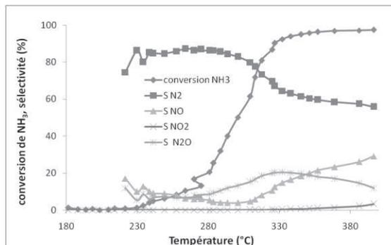
Figure 7 : conversion de l'ammoniac et sélectivité du catalyseur CuO/CuAl<sub>2</sub>O<sub>3</sub> préparé par le procédé sol gel.
