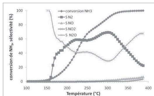
Figure 7 : conversion de l'ammoniac et sélectivité du catalyseur Ag-Mn-CuO-CuCr<sub>2</sub>O<sub>4</sub> préparé par le procédé sol gel.
