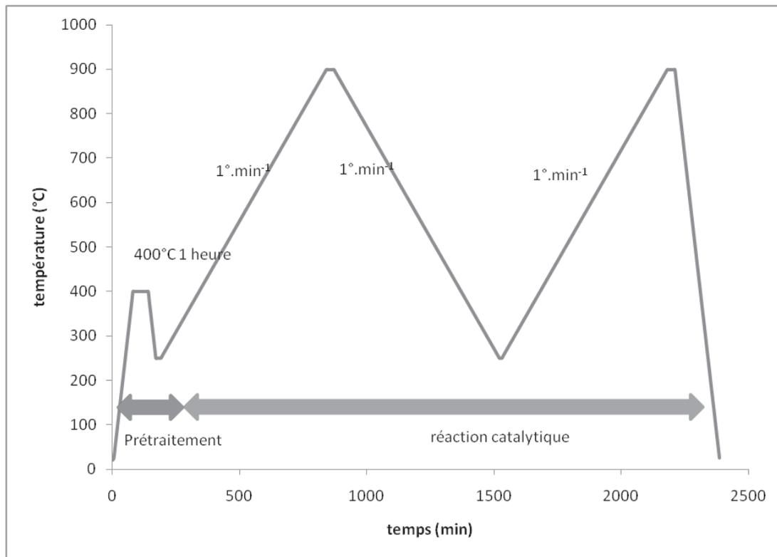
**Figure 7 : protocole expérimental du prétraitement du catalyseur et des tests catalytiques de combustion du méthane**
