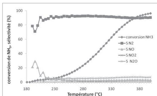
Figure 5 : conversion de l'ammoniac et sélectivité du catalyseur CuO/CuAl<sub>2</sub>O<sub>3</sub> préparé par la méthode « carb Hy ».
