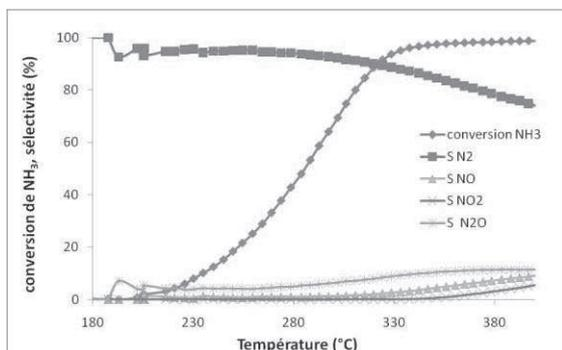
Figure 2 : conversion de l'ammoniac et sélectivité du catalyseur CuO/CuAl<sub>2</sub>O<sub>3</sub> préparé par la méthode « prop ».
