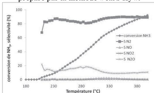
Figure 6 : conversion de l'ammoniac et sélectivité du catalyseur CuO/CuAl<sub>2</sub>O<sub>3</sub> préparé par la méthode « hydro Hy ».
