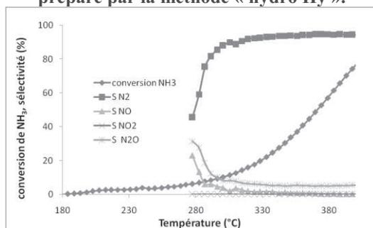
Figure 7 : conversion de l'ammoniac et sélectivité du catalyseur CuO/CuAl<sub>2</sub>O<sub>3</sub> préparé par le procédé sol gel.
