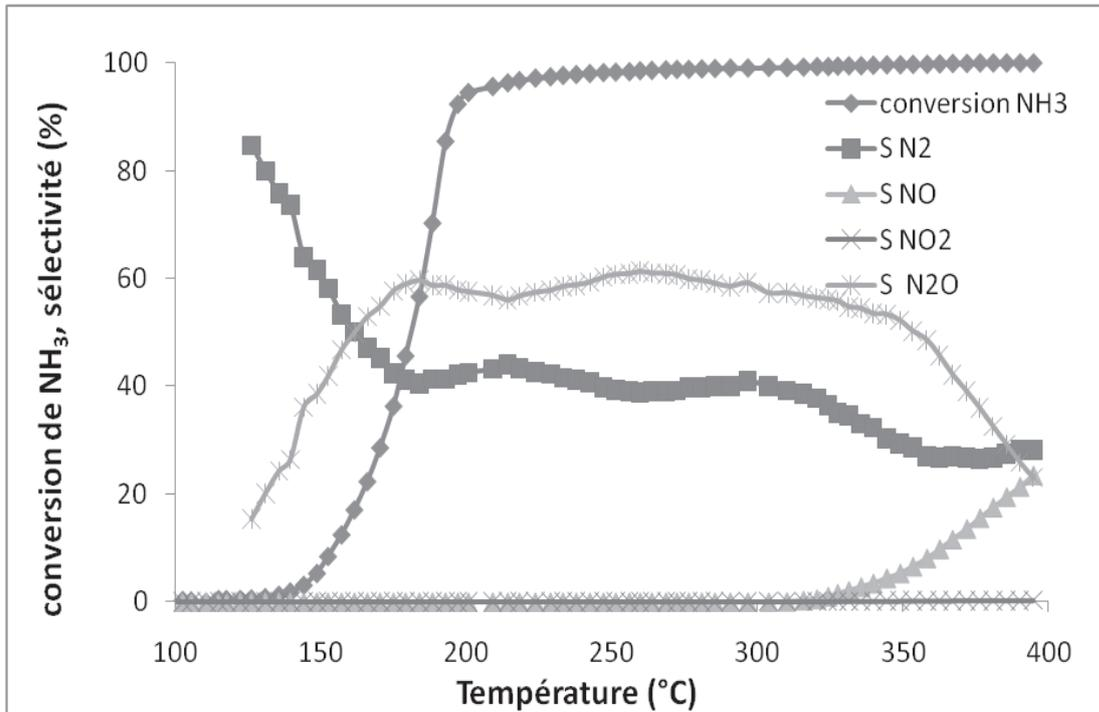
Figure 10 : conversion de l'ammoniac et sélectivité des différents produits formés en présence du catalyseur Ag-CuO-ZnO-Al<sub>2</sub>O<sub>3</sub>.
