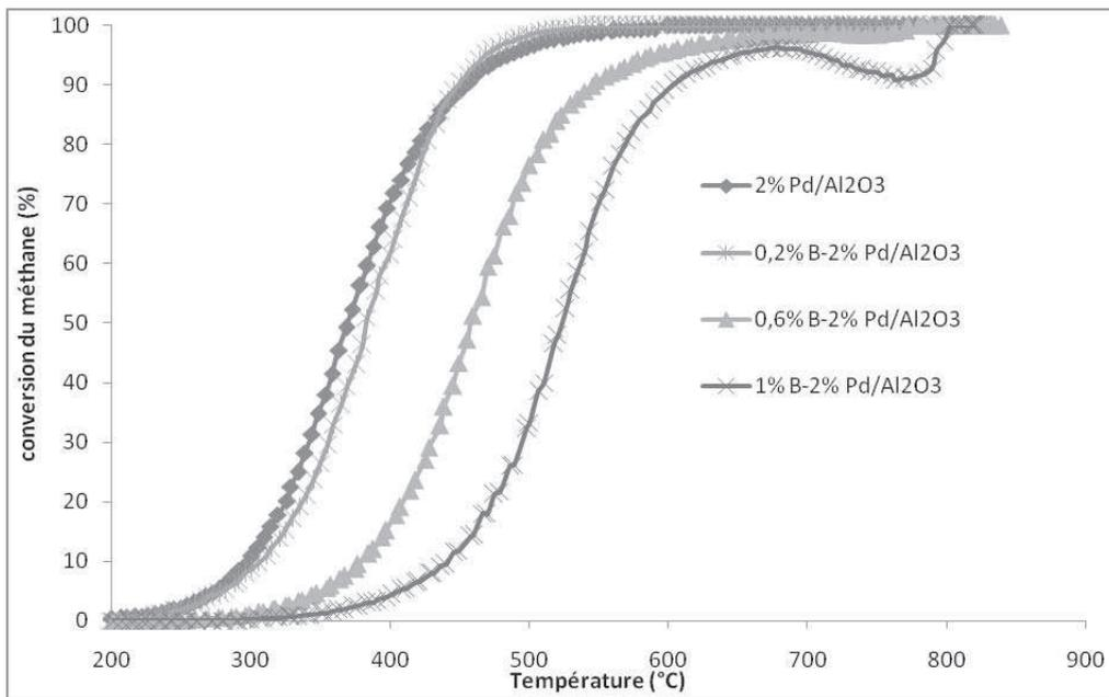
Figure 9 : conversion du méthane en fonction de la température pour les catalyseurs 2% Pd/Al<sub>2</sub>O<sub>3</sub> à l'état vieilli et x% B-2% Pd/Al<sub>2</sub>O<sub>3</sub> (0,2 ≤ x ≤ 1) lors de la seconde montée
