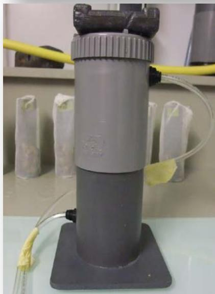
**Fig. 57. Chambres d'incubation utilisées pour les gastéropodes.**
