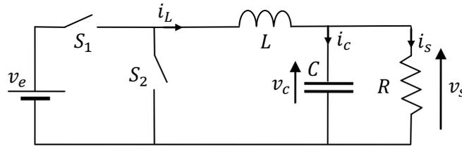
Figure 4.1.1 : Schéma du convertisseur buck sans pertes.
