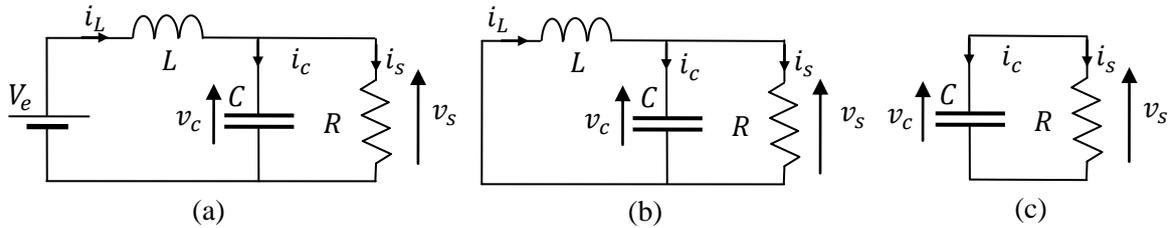
Figure 3.4.1.2 : Configurations du circuit idéal du convertisseur buck : en CCM ((a) et (b)), en DCM ((a), (b) et (c)).
