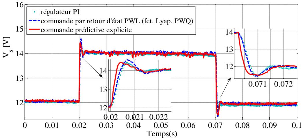
Figure 5.2.4 : Tension de sortie  $V_s$  obtenue expérimentalement pour une variation de consigne  $V_{ref} : 12[V] - 14[V] - 12[V]$ .
