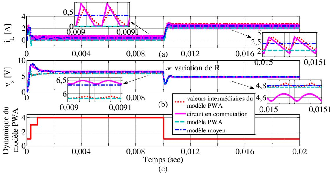
Figure 3.4.1.8 : Changement du mode de fonctionnement (DCM → CCM) du convertisseur buck
