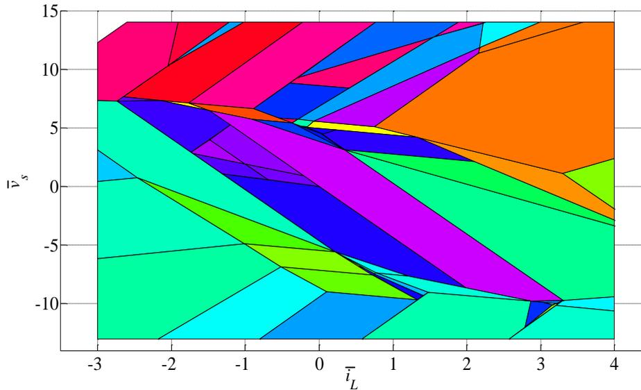
Figure 5.1.2 : Partitions du domaine de définition de la commande PWA représentées en fonction des valeurs décalées  $\bar{i}_L$  et  $\bar{v}_s$ , suite à l'intersection en préalable du domaine 4D de l'espace d'état avec les valeurs à l'équilibre du rapport cyclique  $\bar{d}(k-1)=0$  et la tension de référence  $\bar{V}_{ref} = 0$ .
