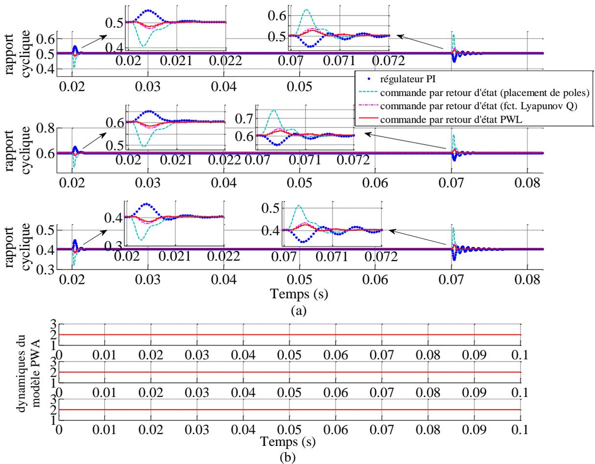
Figure 4.1.9 : Rapport cyclique (a) généré en simulation et dynamiques du modèle hybride (b) pour une variation de la charge  $R : 6[\Omega] - 3[\Omega] - 6[\Omega]$  à  $V_e = 24[V]$ ,  $V_e = 20[V]$  et  $V_e = 30[V]$ .
