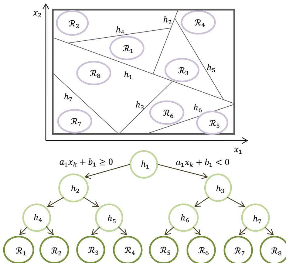
Figure 2.6.2 : Exemple d'arbre binaire construit pour une loi de commande représentée en 2D, définie sur 8 régions qui sont délimitée par 7 hyperplans.
