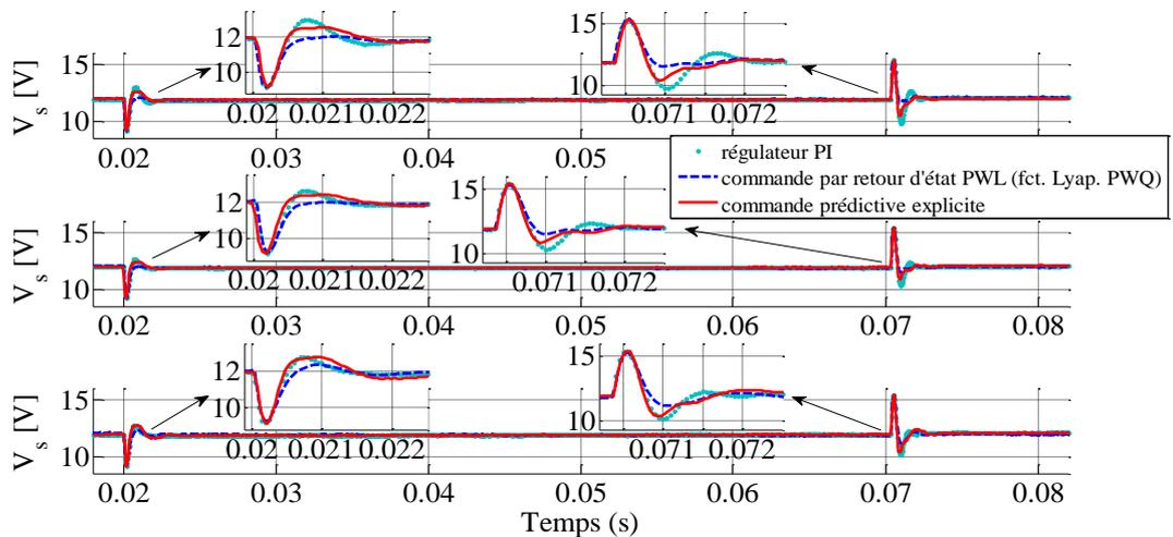
Figure 5.2.8 : Tension de sortie  $V_s$  obtenue expérimentalement pour une variation de la charge  $R : 6[\Omega] - 3[\Omega] - 6[\Omega]$  à  $V_e = 24[V]$ ,  $V_e = 20[V]$  et  $V_e = 30[V]$ .
