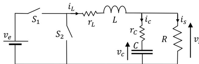
Figure 3.3.1.1 : Schéma du convertisseur buck avec pertes.
