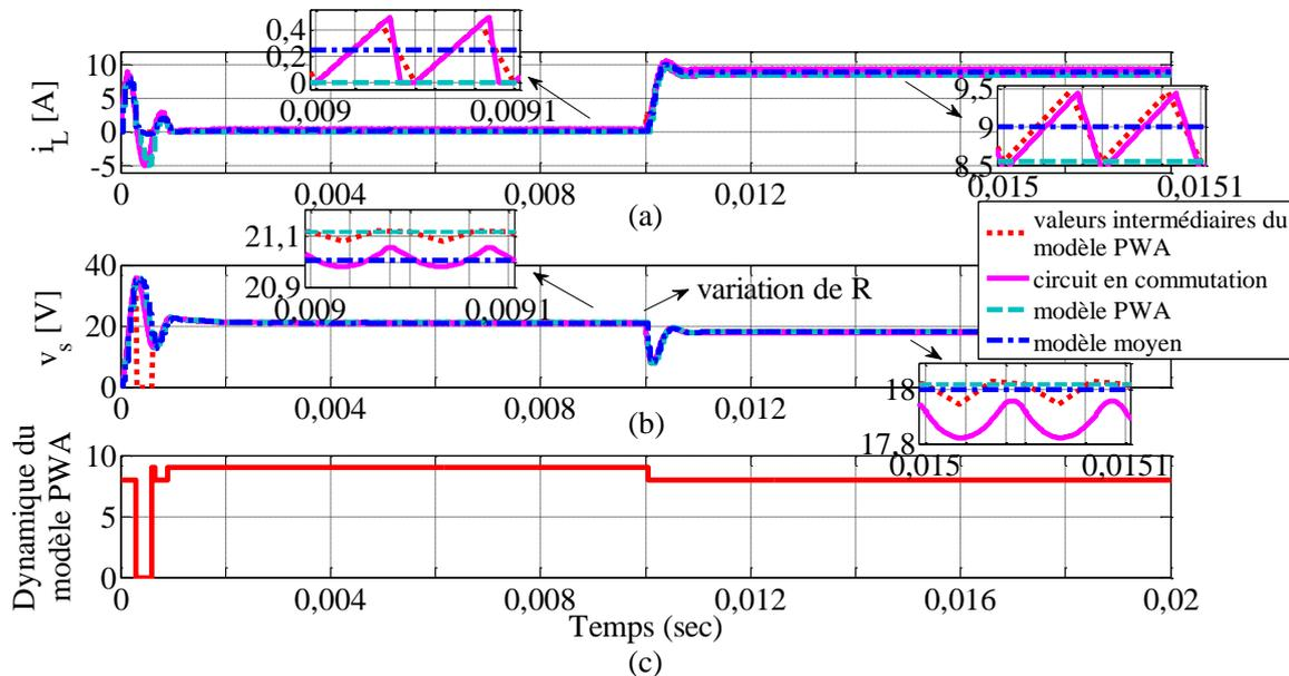
Figure 3.4.1.12 : Changement du mode de fonctionnement (DCM → CCM) du convertisseur buck
