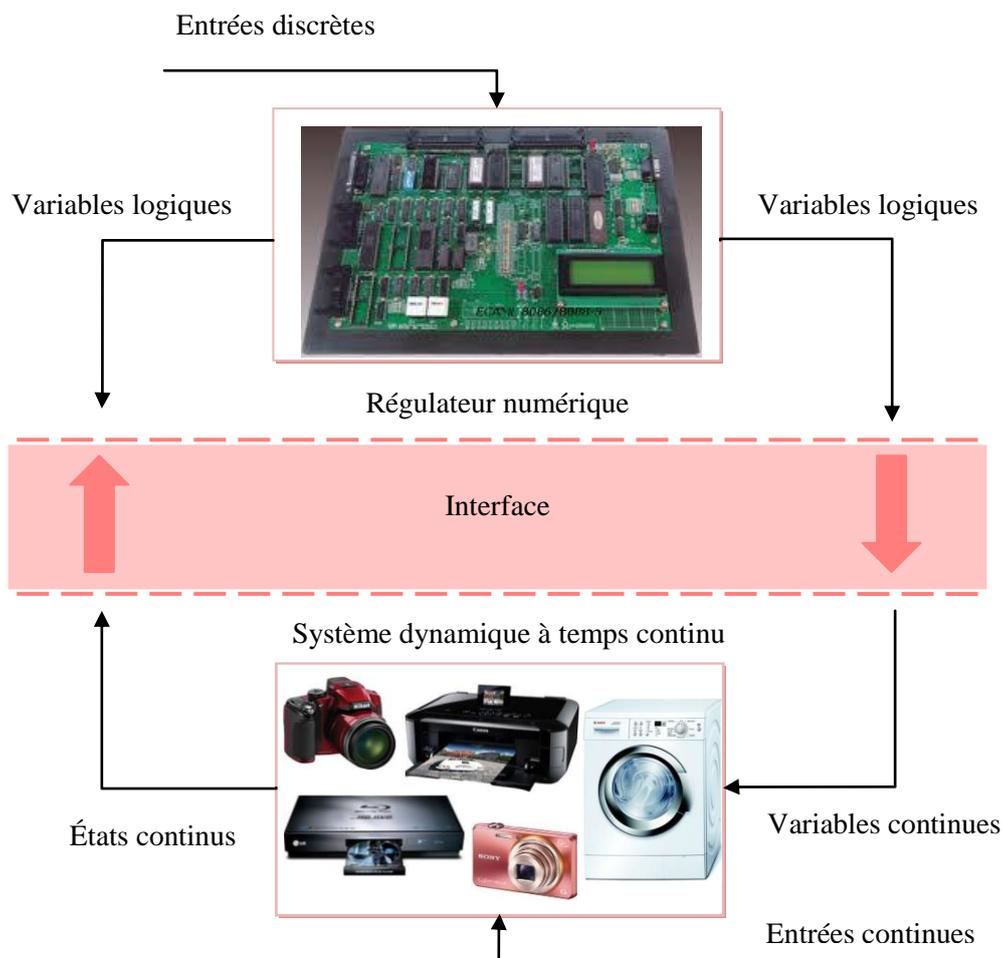
Figure 2.1 (a) : Schéma d'un système hybride.
