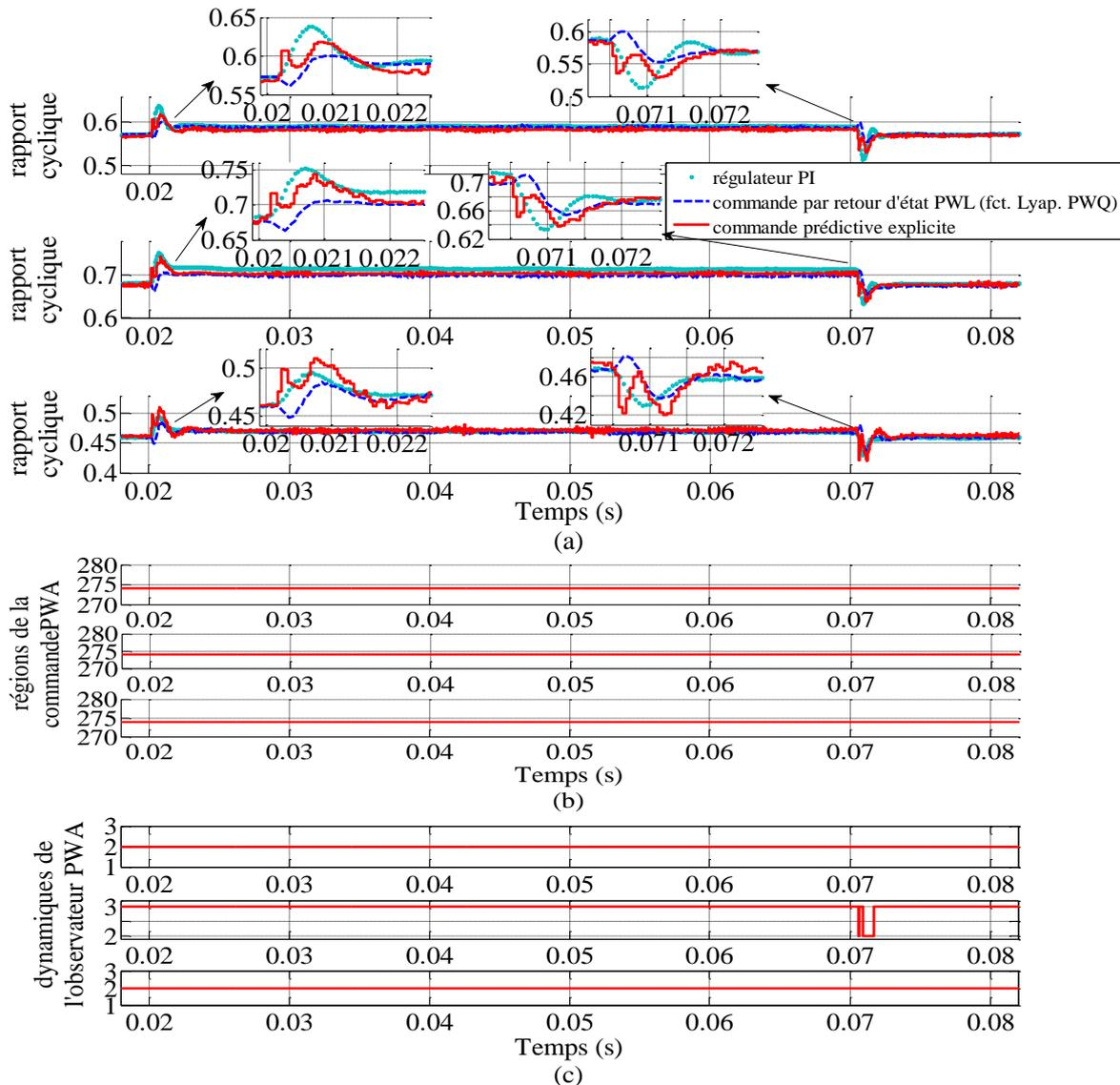
Figure 5.2.9 : Rapport cyclique (a) généré expérimentalement, régions de la commande PWA (b) et dynamiques du modèle hybride utilisées par l'observateur (c) pour une variation de la charge  $R : 6[\Omega] - 3[\Omega] - 6[\Omega]$  à  $V_e = 24[V]$ ,  $V_e = 20[V]$  et  $V_e = 30[V]$ .
