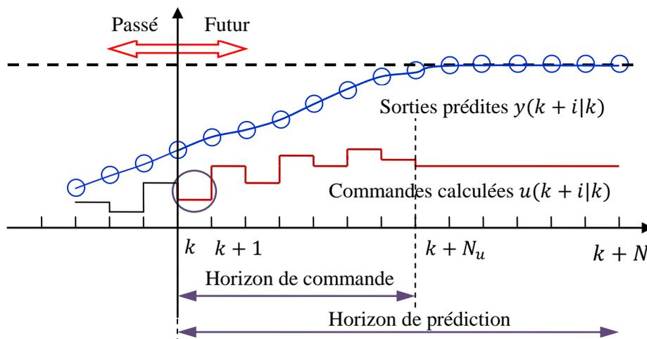
Figure 2.3.1 : Schéma du principe de l'horizon fuyant.
