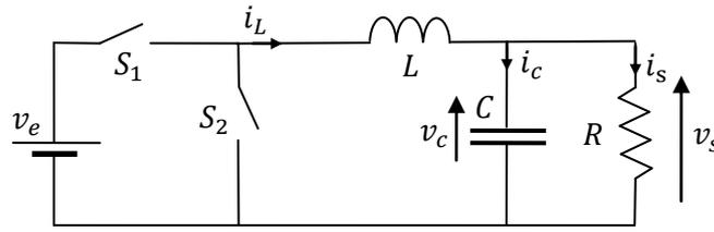
Figure 5.1.1 : Schéma du convertisseur buck sans pertes.
