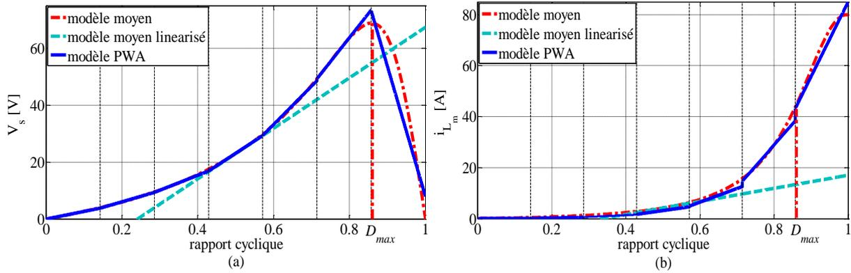
Figure 3.3.2.4 : Caractéristiques en régime permanent de la tension de sortie  $V_s$  (a) et du courant de l'inductance  $L_m$  (b) du modèle PWA continu par rapport à la tension de sortie et la résolution  $\nu = 7$ .
