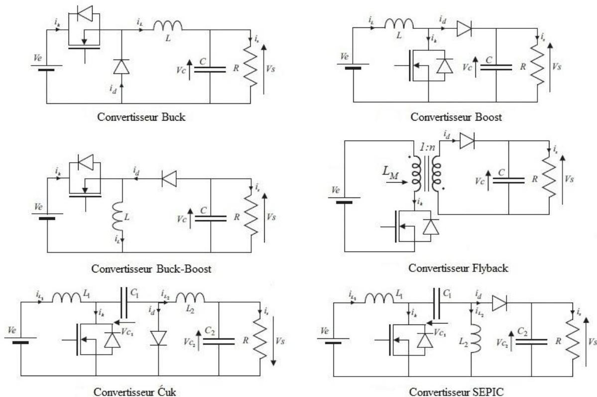
Figure 1 : Circuits représentatifs des convertisseurs de puissance DC-DC.
