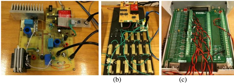
Figure 4.1.2 : Prototype du convertisseur buck (a), banc de variation de charge (b) et carte d'acquisition « xPC Target ».
