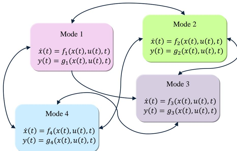
Figure. 2.1 (b) : Système hybride avec 4 modes de fonctionnement.
