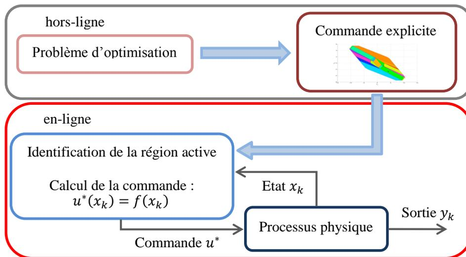
Figure 2.6.1 : Schéma d'implantation de la commande prédictive explicite
