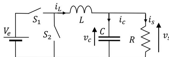
Figure 3.4.1.1 : Circuit idéal du convertisseur buck.
