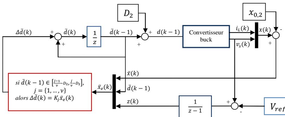
Figure 4.1.3 : Schéma de la commande à gains commutés.
