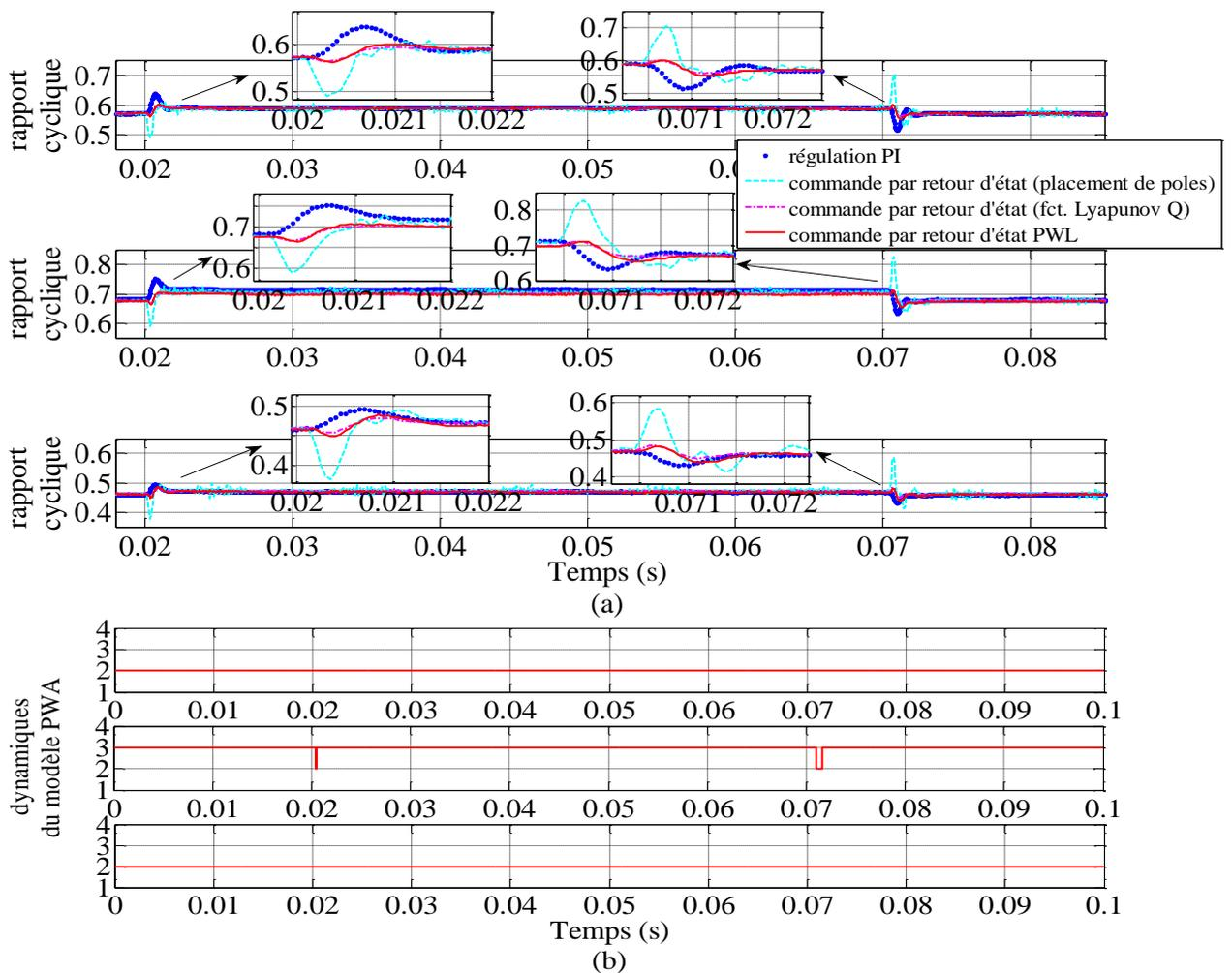
Figure 4.1.11 : Rapport cyclique (a) généré expérimentalement et dynamiques du modèle hybride (b) pour une variation de la charge  $R : 6[\Omega] - 3[\Omega] - 6[\Omega]$  à  $V_e = 24[V]$ ,  $V_e = 20[V]$  et  $V_e = 30[V]$ .
