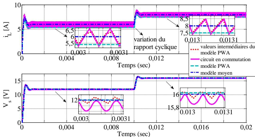
Figure 3.3.1.7 : Formes d'ondes du courant  $i_L$  et de la tension  $V_s$  pour un échelon du rapport cyclique de  $D = 0,55$  à  $D = 0,733$ . Comparaison entre le circuit en commutation, le modèle PWA et le modèle moyen. Les valeurs intermédiaires des variables d'état déterminées en utilisant le modèle hybride sont représentées en trait pointillé.
