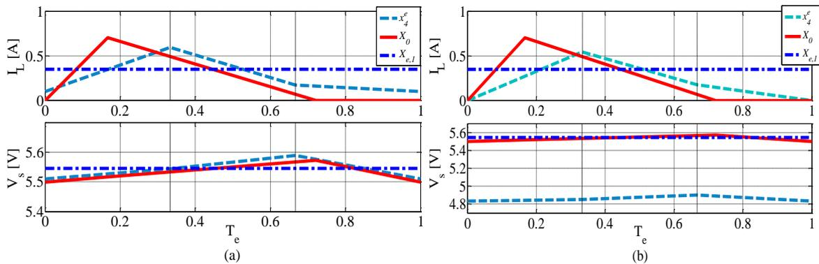
Figure 3.4.1.5 : Point d'équilibre  $x_4^e$  avant (a) et après (b) l'introduction d'éléments zéro dans la matrice  $A_{DCM_{2,1,3}}^d$ . Comparaison avec la valeur exacte du point d'équilibre  $X_0$  et avec la valeur moyenne  $X_{e,1}$ .
