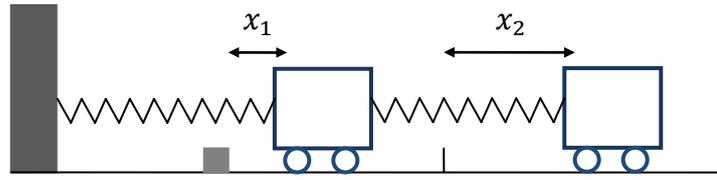
Figure 2.1.2 : Système composé par deux chariots, qui peut être exprimé par un modèle hybride de type LC [HSW00].
