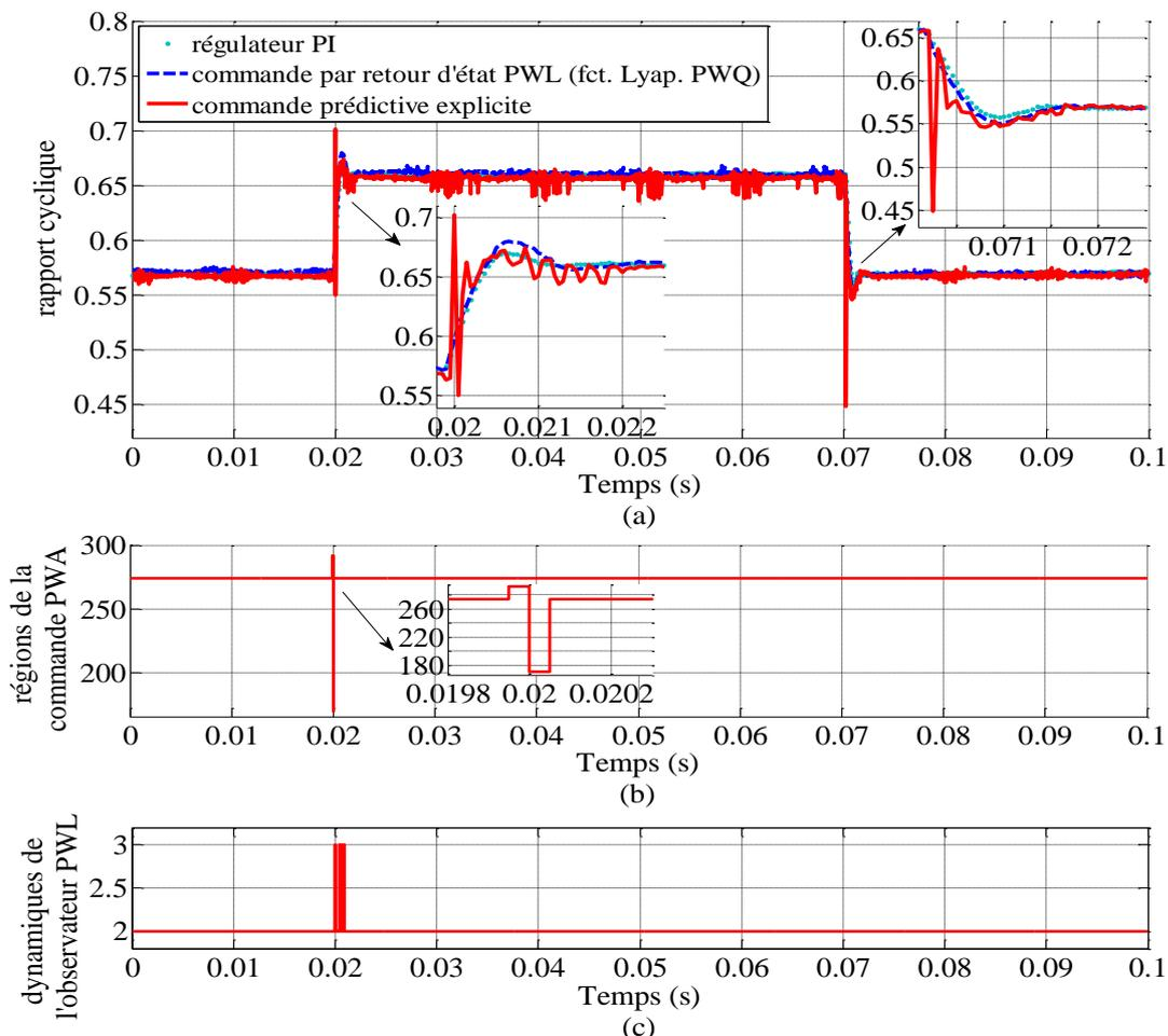
Figure 5.2.5 : Rapport cyclique (a) généré expérimentalement, régions de la commande PWA (b) et dynamiques du modèle hybride utilisées par l'observateur (c) pour une variation de consigne  $V_{ref} : 12[V] - 14[V] - 12[V]$ .
