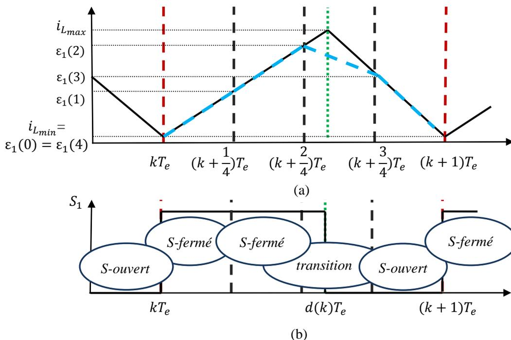
Figure 3.3.1.3 : Modélisation avec une résolution  $\nu = 4$ . Évolution du courant d'inductance  $i_L$  du modèle moyen bilinéaire à temps continu (ligne continue) en comparaison avec les états donnés par le modèle hybride (ligne en pointillés) sur une période de commutation  $T_e$  (a). Position de l'interrupteur  $S_1$  dans chaque sous-période (b).
