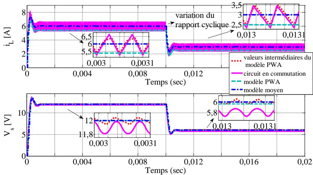
Figure 3.3.1.6 : Formes d'ondes du courant  $i_L$  et de la tension  $V_s$  pour un échelon du rapport cyclique de  $D = 0,55$  à  $D = 0,275$ . Comparaison entre le circuit en commutation, le modèle PWA et le modèle moyen. Les valeurs intermédiaires des variables d'état déterminées en utilisant le modèle hybride sont représentées en trait pointillé.
