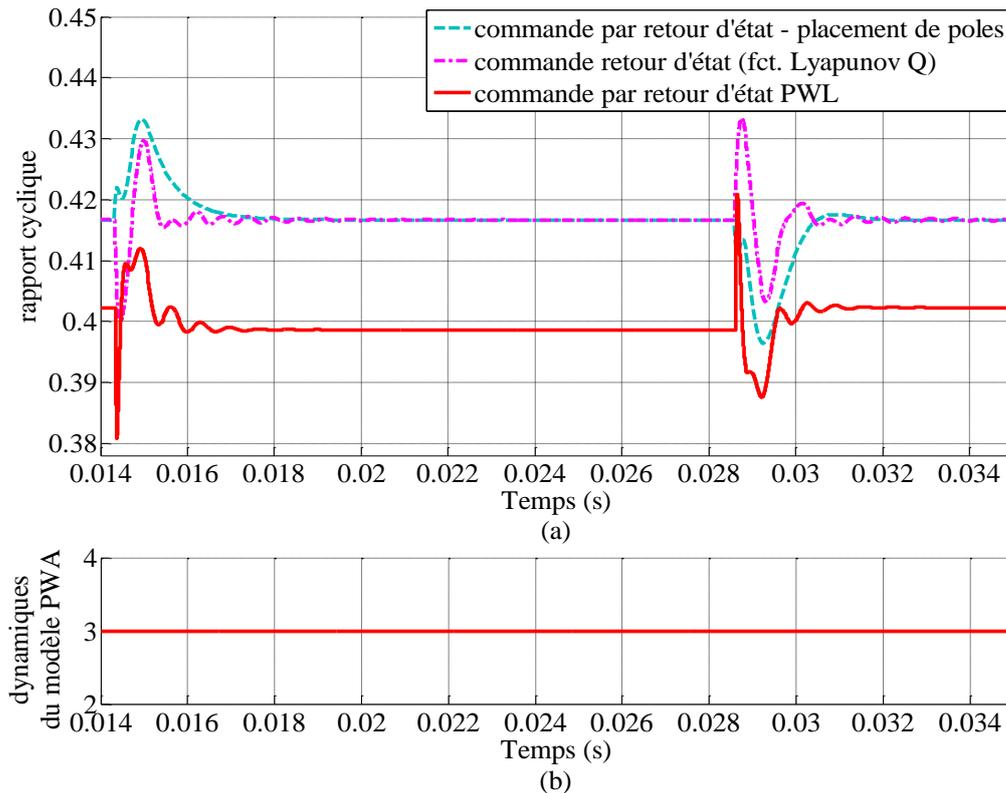
Figure 4.2.12 : Rapport cyclique (a) généré en simulation et dynamiques du modèle hybride (b) pour des variations de la charge  $R : 22[\Omega] - 11[\Omega] - 22[\Omega]$  à  $V_e = 12[V]$  et  $V_{ref} = 16[V]$ .
