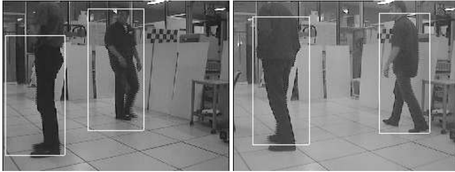
FIG. 4.10 – Exemples d'objets en mouvement : ici, l'action détecte grossièrement la zone comprenant les objets. En bas de chaque fenêtre, l'intersection de la fenêtre avec le sol entraîne une sous estimation de la valeur de la profondeur, avec une erreur inférieure à 50 cm.
