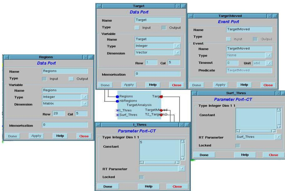
FIG. 6.4 – Spécification des ports d'un module algorithmique
