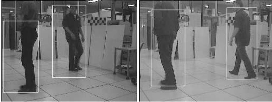
FIG. 4.10 – Exemples d'objets en mouvement : ici, l'action détecte grossièrement la zone comprenant les objets. En bas de chaque fenêtre, l'intersection de la fenêtre avec le sol entraîne une sous estimation de la valeur de la profondeur, avec une erreur inférieure à 50 cm.
