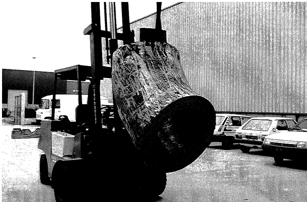
FIG. 1.2 – le coude est d'épaisseur 10 cm et de diamètre 1m.
